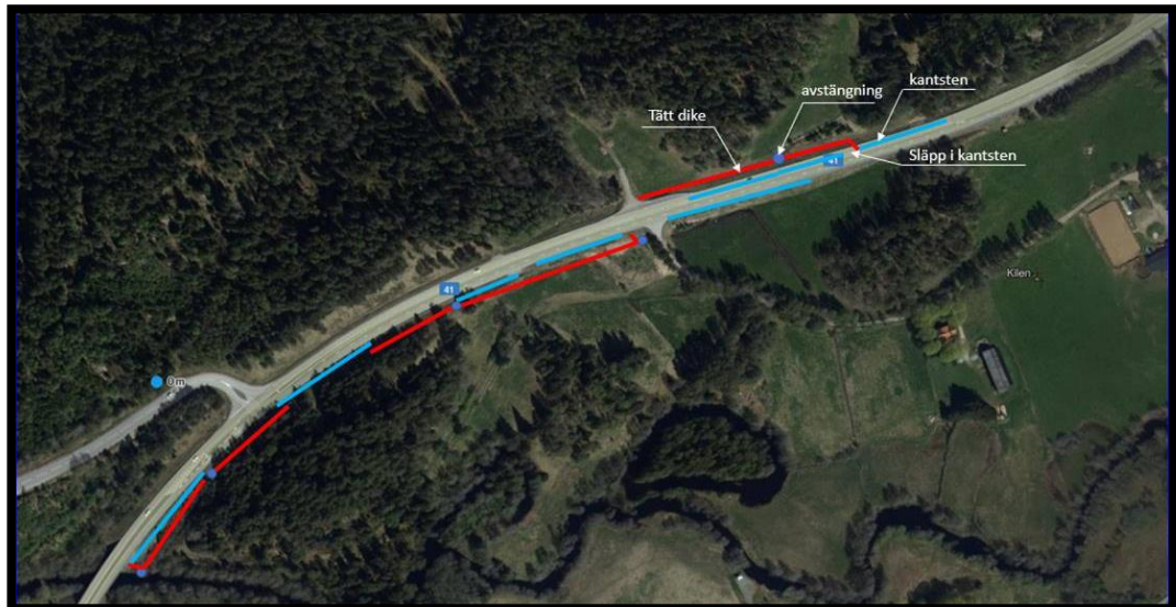
Figur 21. Föreslaget uppsamlingssystem för vägdragvatten inom primär skyddszon.
