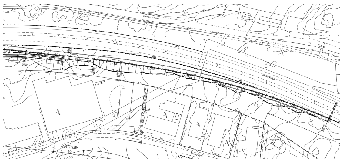
Figur 7. Utsnitt ur tidigare arbetsplanens norra del. Bussrampen korsade två större vattenledningar, vilket syns i figuren.
