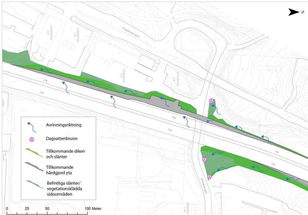
Figur 13. Schematisk avvattningsprincip för den södergående hållplatsen.
