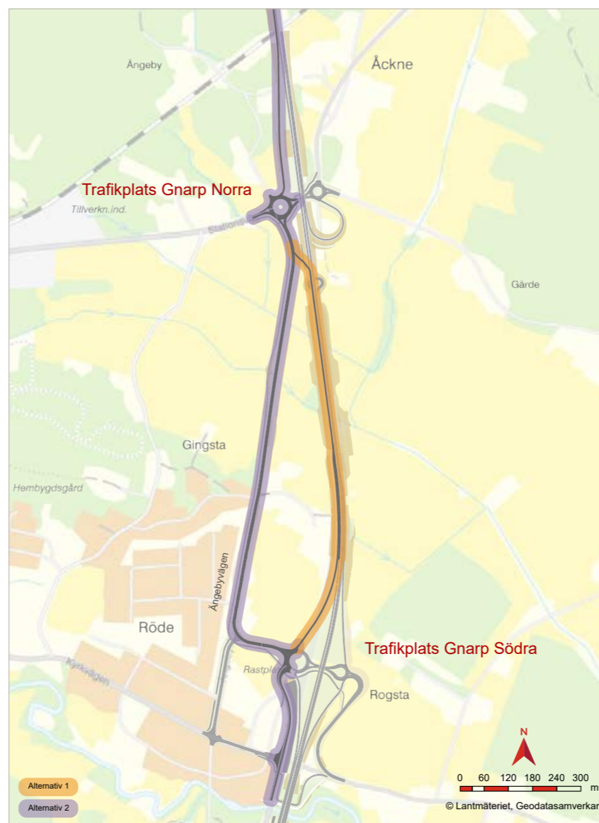
Figur 6.4:1. I Gnarp ska ny E4 ansluta till befintlig väg, två trafikplatser anläggas och Ångebyvägen justeras. Detta kräver en stegvis ombyggnad och omläggning av trafiken. Möjliga vägar för omledning av E4-trafik under byggskedet är inom vägområdet (Alternativ 1) eller via Ångebyvägen (Alternativ 2).
