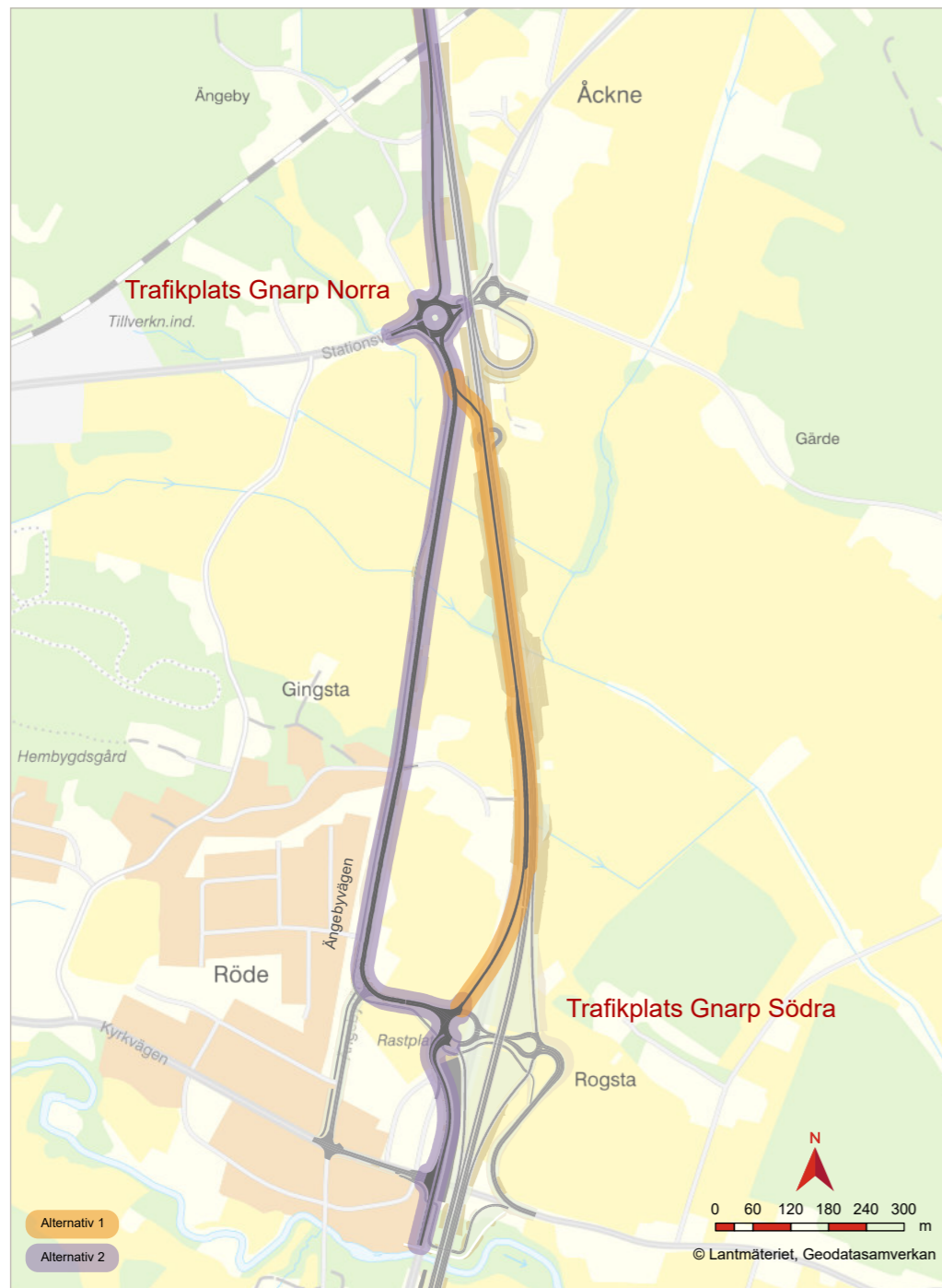
Figur 10.4.1. I Gnarp ska ny E4 ansluta till befintlig väg, två trafikplatser anläggas och Ångebyvägen justeras. Detta kräver en stegvis ombyggnad och omläggning av trafiken. Möjliga vägar för omledning av E4-trafik under byggskedet är inom vägområdet (Alternativ 1) eller via Ångebyvägen (Alternativ 2).
