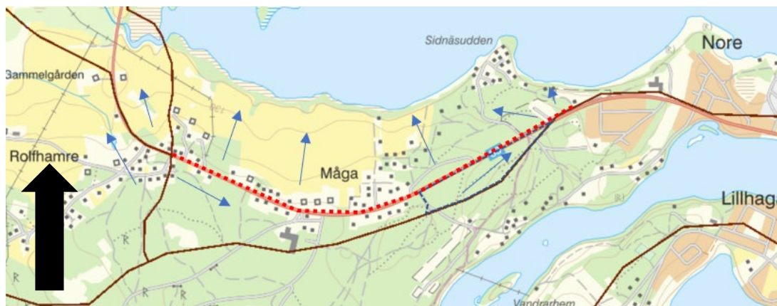
Figur 10. Flödesvägar inom delavrinningsområdet Utloppet av Växnan, illustrerade med blå flödespilar. Vägplanen illustrerade med röd streckad linje.
