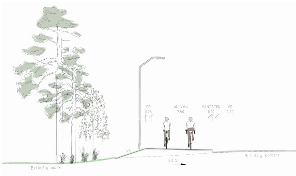
Figur 13. Utformning av GC-vägen med kantsten i trängre partier där inte skiljeremsa tillåts
