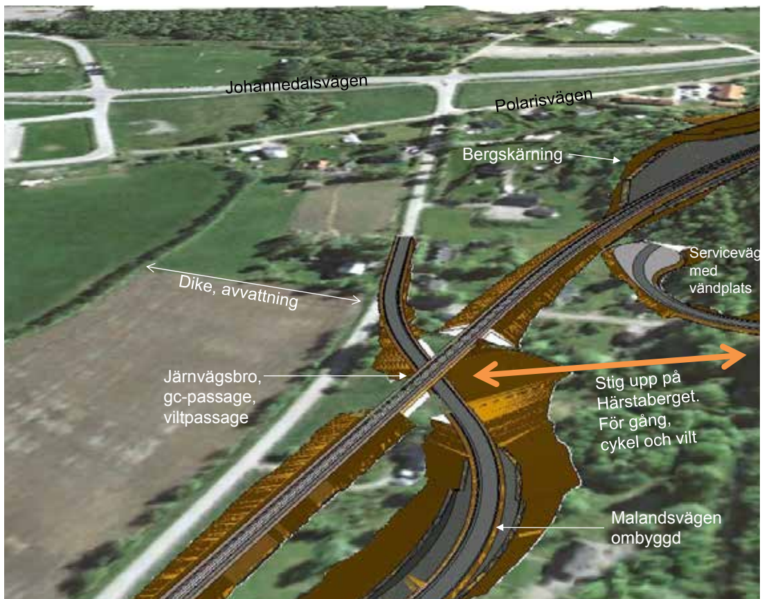
Figur 4.3:1 Järnvägsbro över ny dragning av Malandsvägen med vilt passage.
