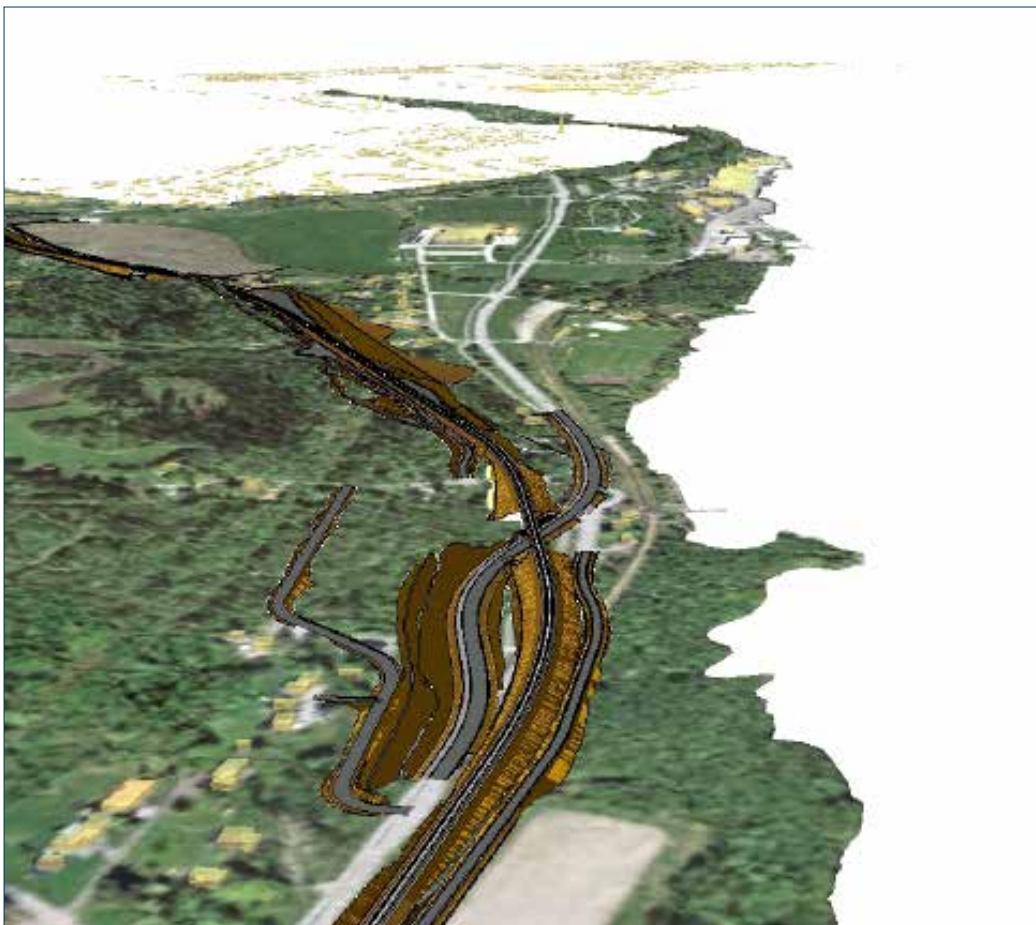
Figur 8:7 Järnvägen på bro över Johannedalsvägen som byggs om, vy norrut.
