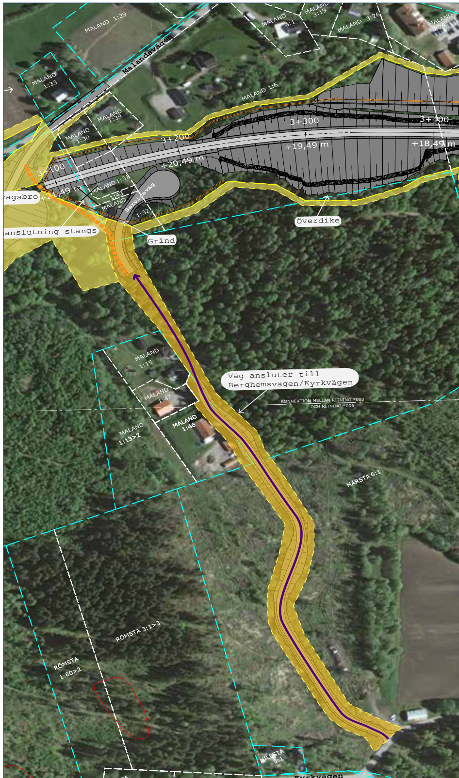
Figur 7:11 V3C och V3KOB. Befintliga dalgångsstråket stängs närmast Malandsvägen. Den stängda sträckan ersätts med en stig som möjliggör promenader och att funktionen som viltpassage tillgodoses. För de tre husen uppe på berget anläggs istället en mindre väg på södra sidan som ansluter till Kyrkvägen och Berghemsvägen.
