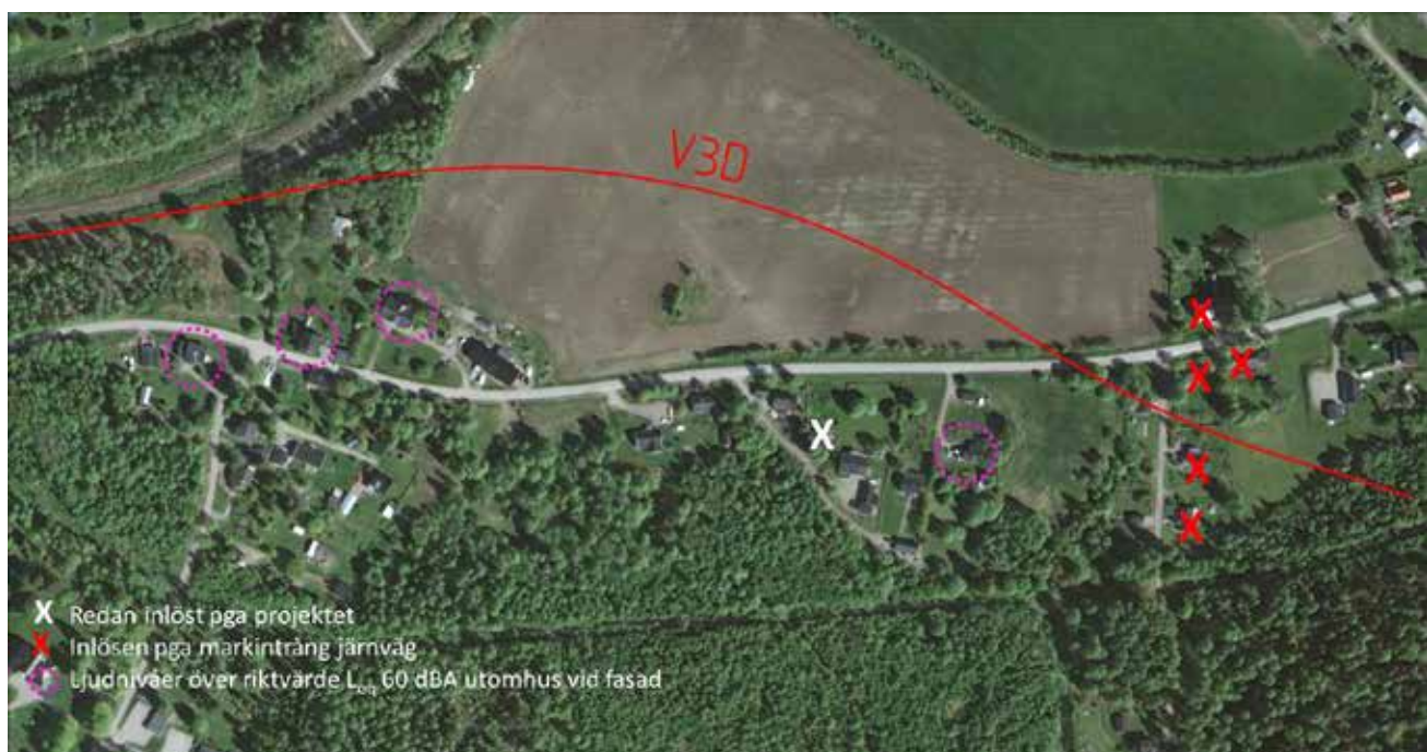
Figur 7:32 V3D: Hus som löses in och kvarvarande hus med riktvärdesöverskridanden vid fasad.
