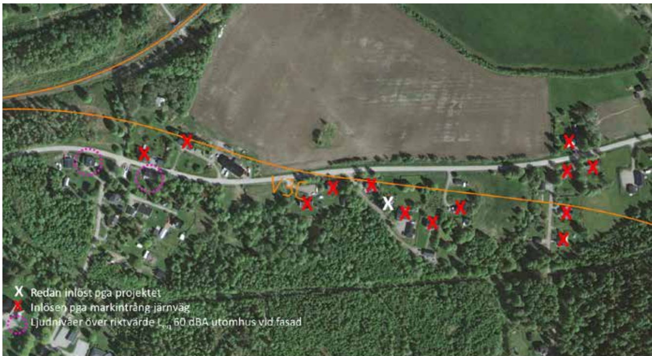
Figur 7:30 V3C: Hus som löses in och kvarvarande hus med riktvärdesöverskridanden vid fasad.
