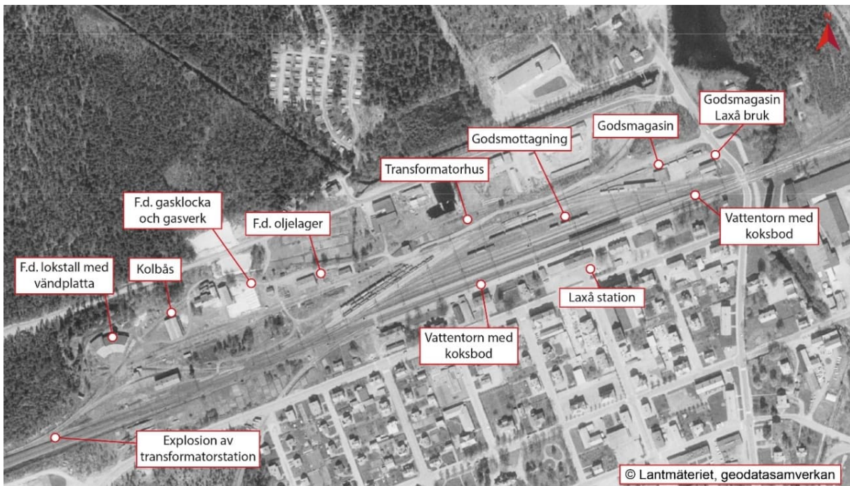
Figur 28. Historisk karta (cirka 1970) med potentiellt förorenade objekt utmarkerade. Laxå stationshus är också markerat för kontext.
