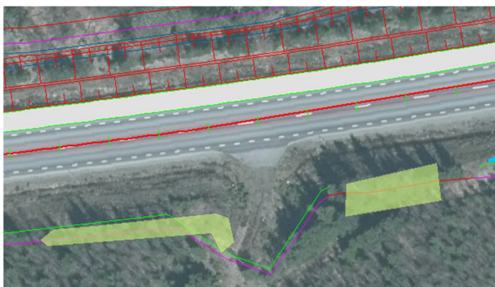
Figur 25. Viltstängslet svänger idag av för att leda till en grind söder om väg 25. När anslutningen stängs kommer grinden tas bort och ett faunastängsel gå parallellt med väg 25. Anslutningen grävs bort och dikey anläggs utmed väg 25.
