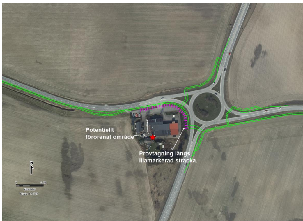
Figur 26 Potentiellt förorenat område vid Klörupskorset beläget ca 50 m söder om vägåtgärd samt planerad miljöprovtagning (lilamarkerad sträcka) för analys i jord.
