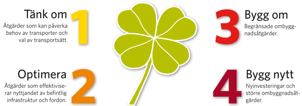
Figur 3 - Schematisk illustration över fyrstegsprincipen. Källa: Trafikverket
