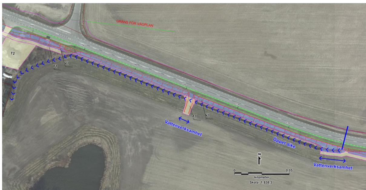
Figur 46: Öppet dike mellan 2/550 och 2/800 och som ingår i båtnadsområde för dikningsföretag Klörup nr 13 av år 1930. Här kommer två stycken 1000 mm lantbrukskulvertar att behöva förlängas. Dessa åtgärder innebär anmälningspliktig vattenverksamhet.
