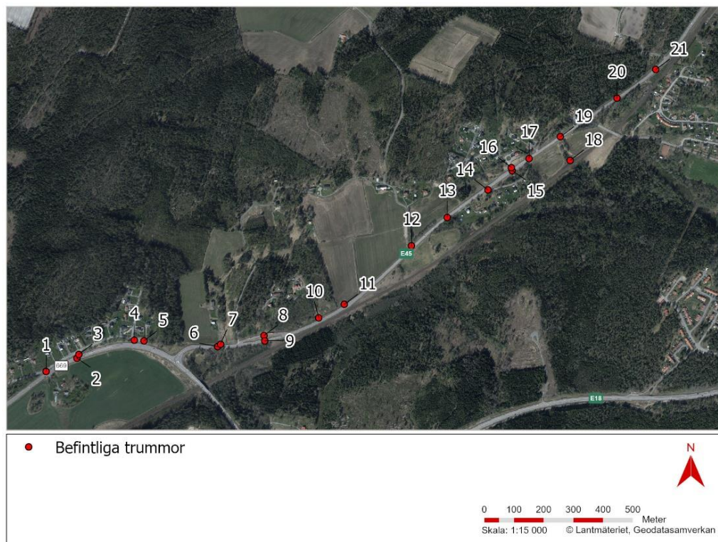
Figur 18. Befintliga trummor längs väg 669 och E45.
