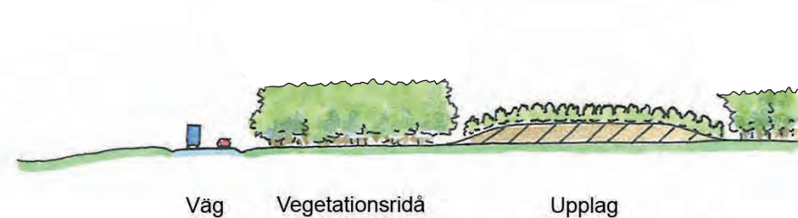
Figur 4.4:15 Vegetationsridå sparas mellan upplag och väg. Upplag återplanteras till skog.
