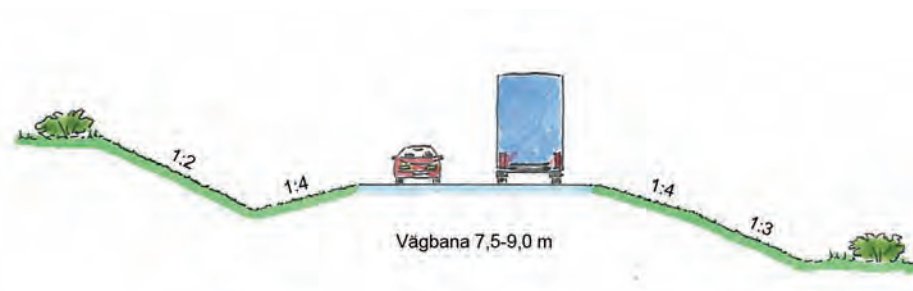
Figur 7.7:2 Principskiss på vägsektion för tvåfăltsvăg med 7,5-9,0 meters bredd utanför tătbebyggt område. För Nikkaluoktavăgen väljs en sektion med vägbredd 7,5-8,0 m.
