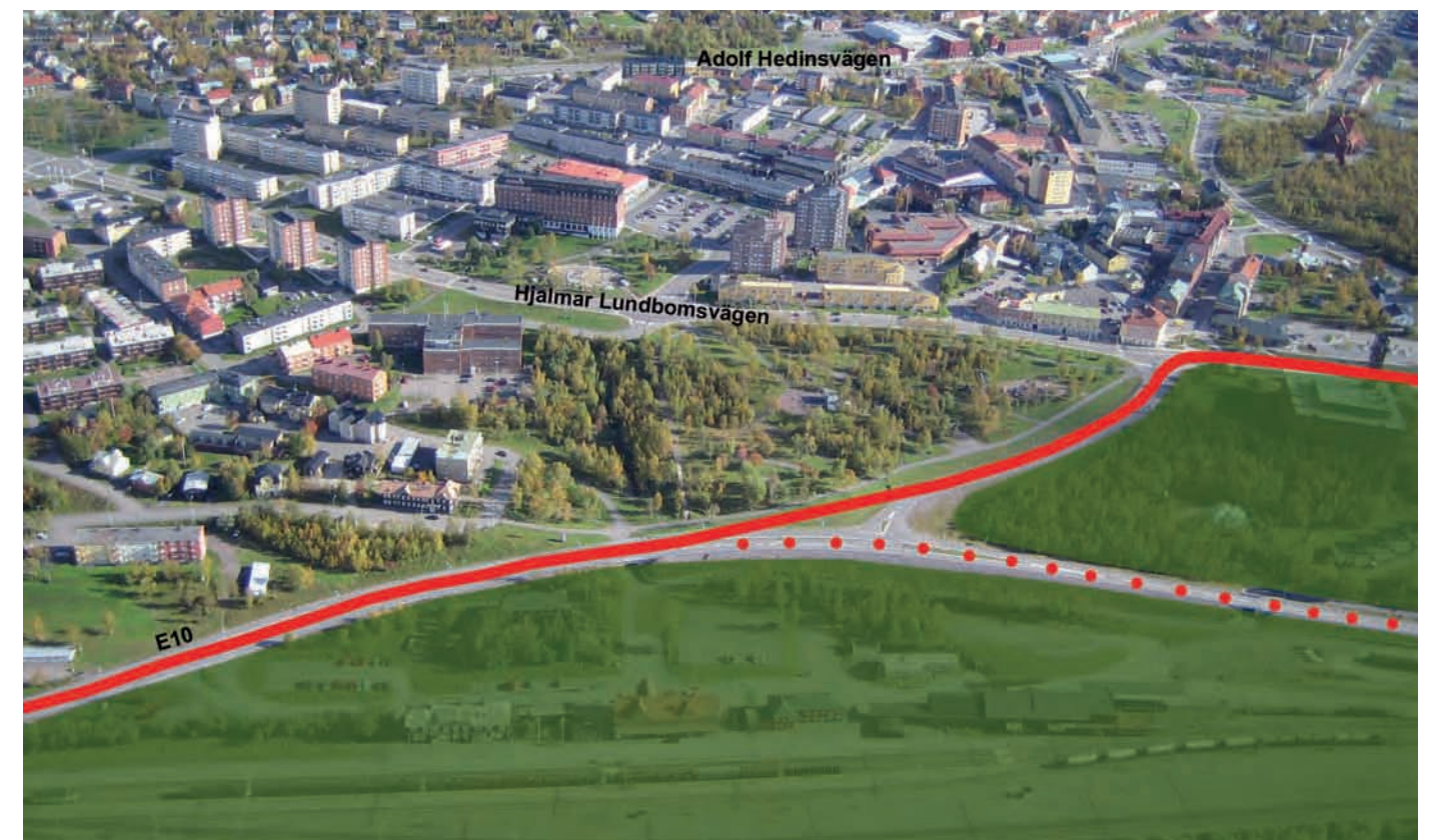
Figur 7.7:22 Flygbildsmontage visande ny sträckning av E10 i Alternativ Ombyggnad etapp 2- Stationsvägen binder samman Hjalmar Lundbomsvägen med dagens E10. Det gröna området visar vad som kan komma att ingå i LKAB:s industriområde och den rödprickade linjen visar sträckningen för dagens E10.
