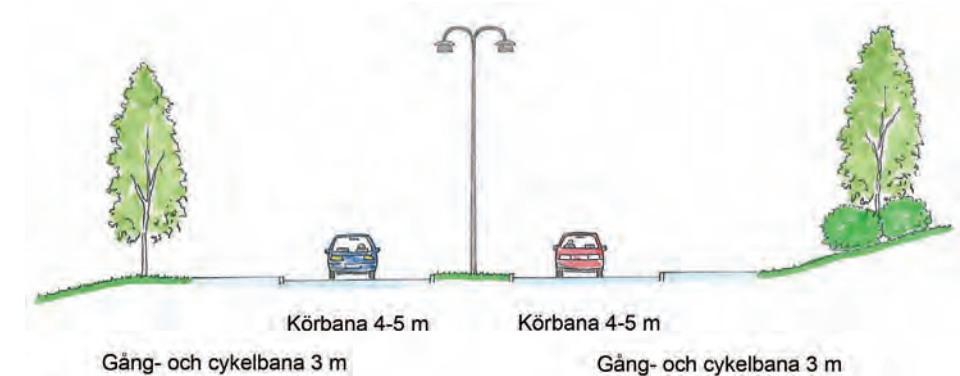
Figur 7.7:4 Principskiss på utformning av gatusektion för vägens centrumnăra delar kantade av grőnytor.
