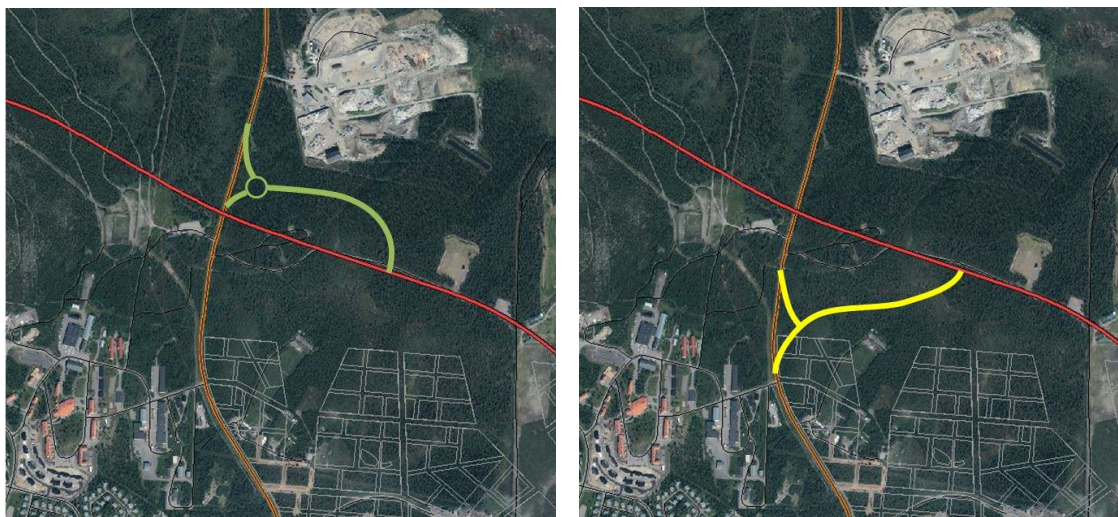
Figur 8. Alt 1–4. 3-vägs korsning på E10, anslutningen mot Kurravaaravägen görs antingen med en 3-vägs korsning eller med en mindre cirkulationsplats
