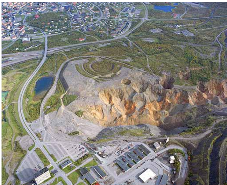
Bild 2. Fotot visar deformation av marken närmast Kiirunavaara. Kratrarna är tydligt synliga tecken på en långt framskriden deformation.
