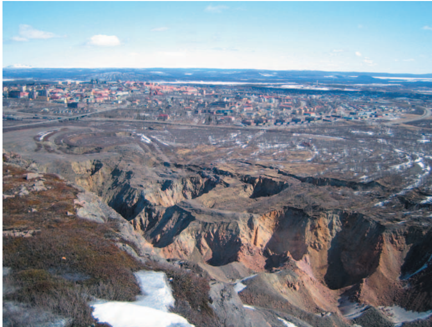
Bild 1.2. Fotot visar deformation av marken närmast Kiirunavaara. Kratrarna är tydligt synliga tecken på en långt framskriden deformation.
