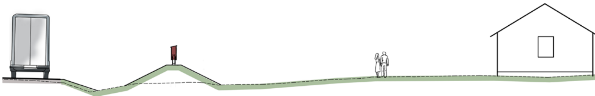
Sektion 42/890. Ungefär 1 meter hög bullerskyddsvall med 1 meter högt plank vid Örminge.
