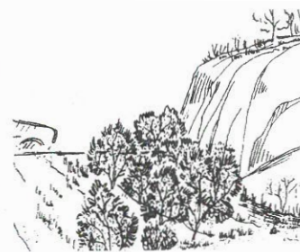
Figur 3.1.7-5. Plantering mjukar upp övergången mellan bank och skärning. Källa: Vegen i landskapet, Statens Vegvesen (1982).
