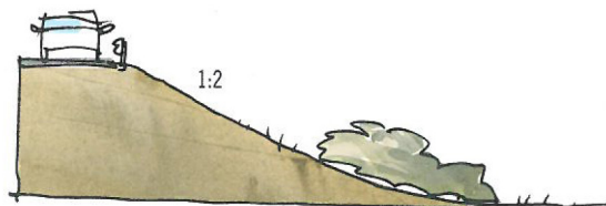
Figur 3.1.7-2. Planteringar görs i bankfot halvägs upp i slänten för att läka ihop landskapet. Källa: Vägen en bok om vägarkitektur (2006).
