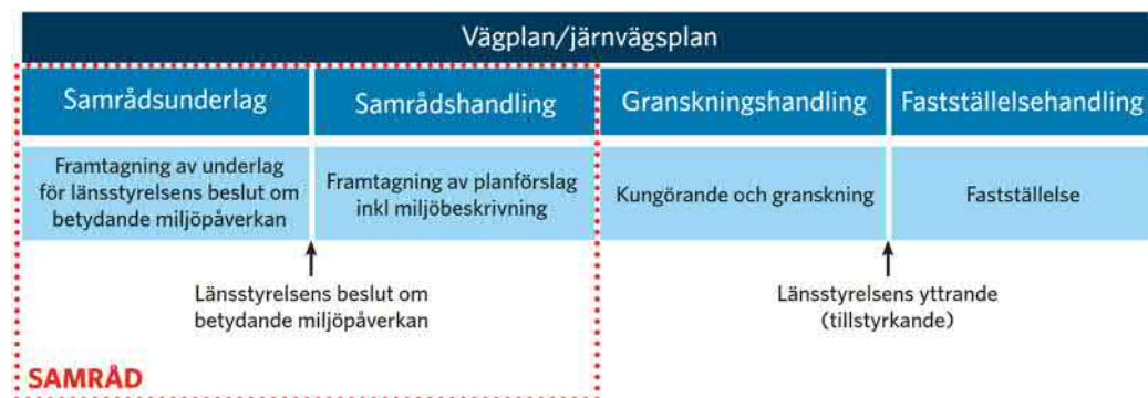
Figur 1: Planlägningsprocessen för en vägplan utan MKB, typfall 2 (Trafikverket, 2020).
