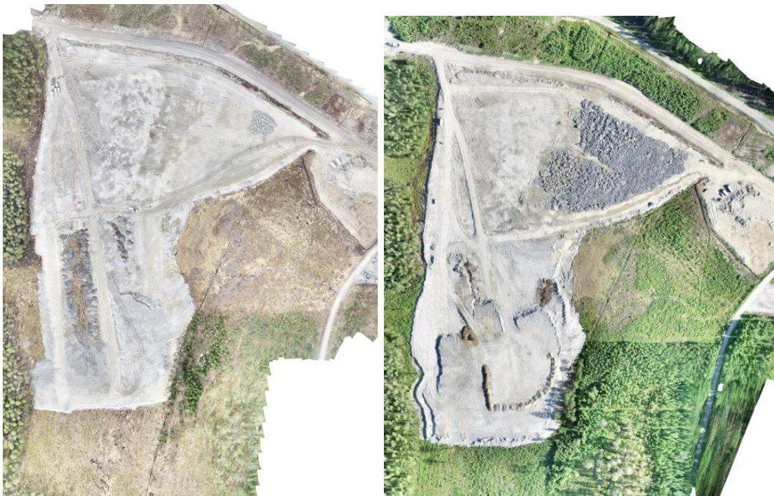
Figur 24: T.v. Flygfoto 2022-05-12, de nedre baljorna är nästan helt fyllda. T.h. Flygfoto 2022-06-16, moränkanter för den övre baljan börjat formas.
