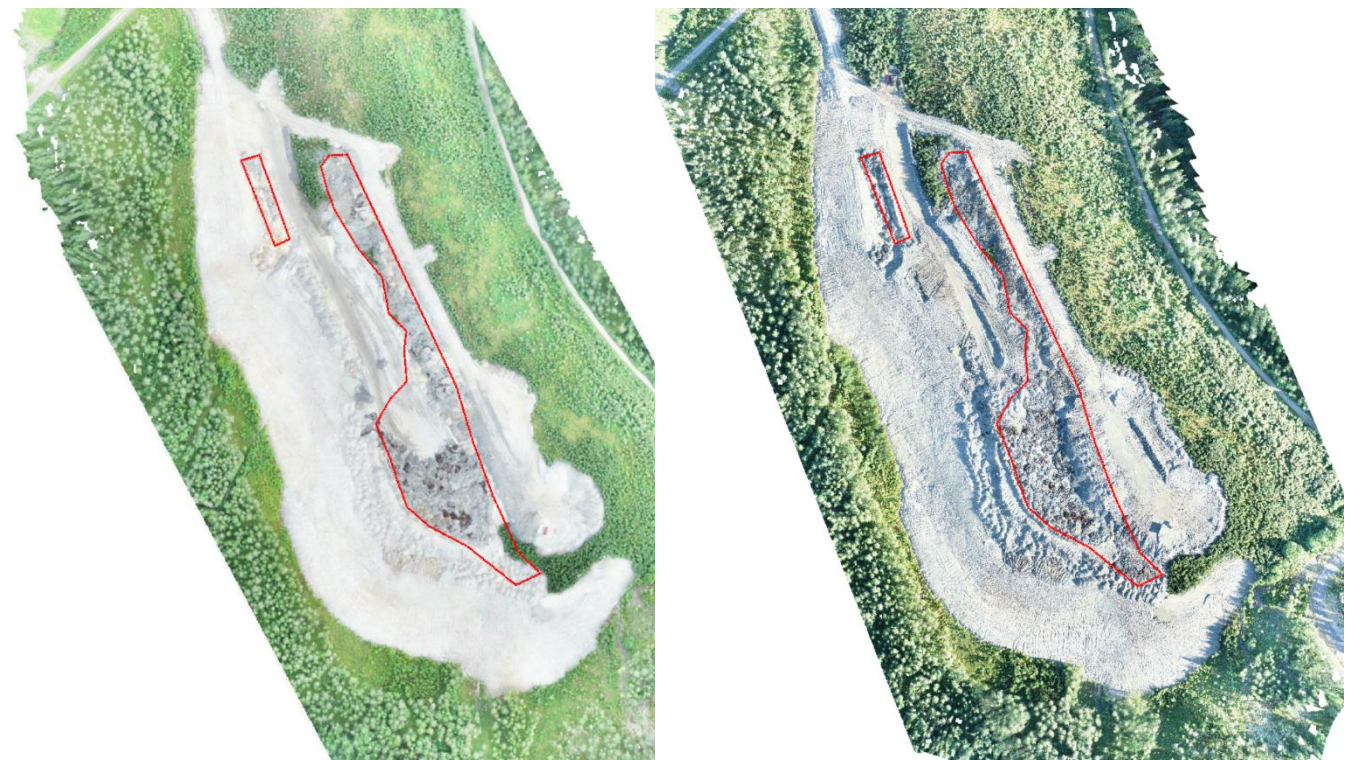
Figur 19: T.v.: Flygfoto 2022-08-15, ytterligare morän har tillförts ytan. Lösa massor och sulfidjord har tillförts den stora baljan. Inga ytterligare lösa massor/sulfidjord har tillförts den lilla baljan. T.h.: Flygfoto 2022-08-24, ytterligare lösa massor har tillförts den stora baljan. Områden (baljor) inom vilka lösa massor och sulfidjord har placerats är markerade i rött på fotona
