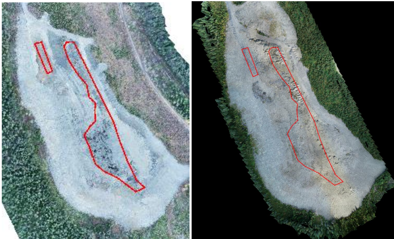
Figur 20: T.v.: Flygfoto 2022-10-18, den lilla baljan är täckt med morän och täckning av den stora baljan pågår. T.h.: Flygfoto 2024-09-04 visar hur T1 ser ut idag. Baljorna är täckta, moränhögar som ännu inte planats ut syns. Områden (baljor) inom vilka lösa massor och sulfidjord har placerats är markerade i rött på fotona
