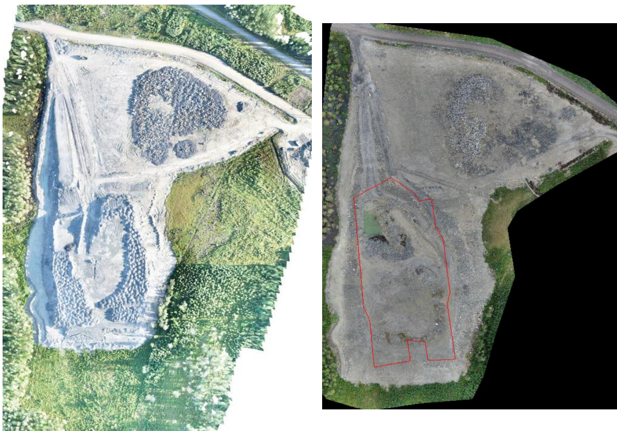
Figur 25: T.v. Flygfoto 2022-08-15, de nedre baljorna är täckta och morän tillförs ytan. T.h. Flygfoto 2023-08-23, transporter till ytan har avslutats. Område inom vilket lösa massor har placerats är markerat i rött.
