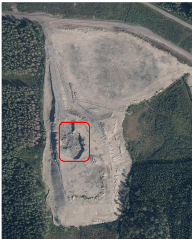
Figur 26: Flygfoto från 2025 med området som tömts på sulfidjord i mars 2024 markerat i rött.
