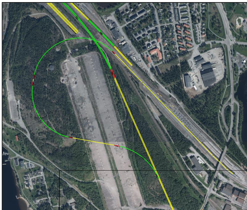
Figur 18: Förslag på spårlösning UA2b – Rundslinga i tunnel (Källa: Funktionsutredning Norrbottniabanan Luleå C, godsanslutning och Luleå-Kallax, Kreera 2023-07-07).
