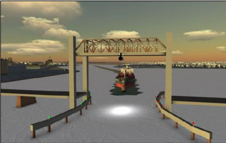
Figur 43: Principskiss på ledverk under en vertikal lyftbro. (Källa: Simulering av förutsättningar för en öppningsbar bro över Svartösundet, Luleå, Sjöfartsverket sept 2022).
