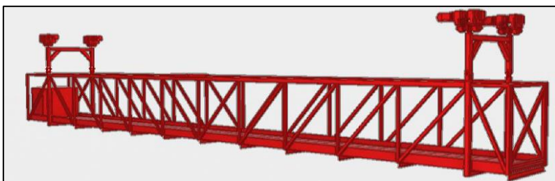
Figur 46: Exempel på utformning av servicevagn för lyftbro. (Källa: Utredning rörlig bro i Luleå med fokus på Luleås klimat, Ramböll 2022-11-08).
