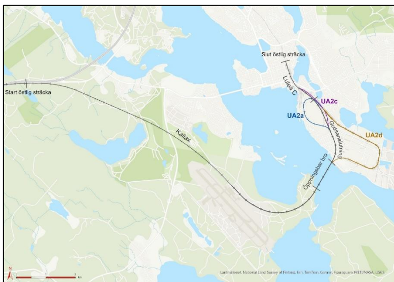
Figur 16: Principskiss godstrafikspår i alternativ OH enligt funktionsutredning (Källa: Trafikverket)
