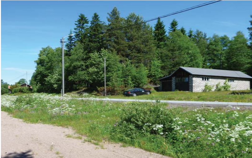
Figur 4.12 Sektion 2/170. Vägen breddas och höjs 0,5 meter vilket gör att den kommer att inkräkta på banvallen. Fotot visar garage, befintlig väg 66 samt banvallen.
