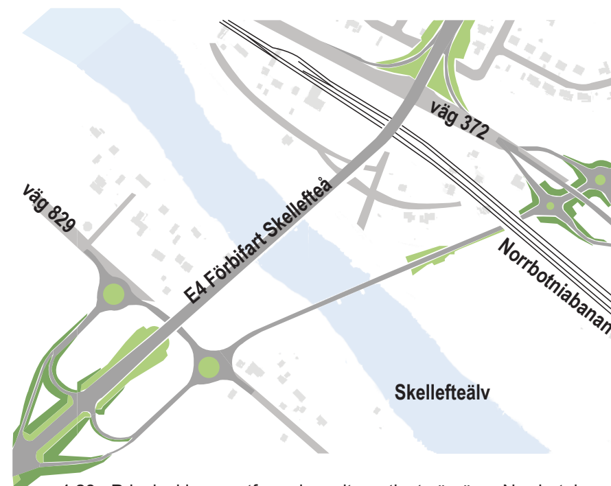
Figur 4.28 Principskiss av utformningsalternativet väg över Norrbotniabanan.
