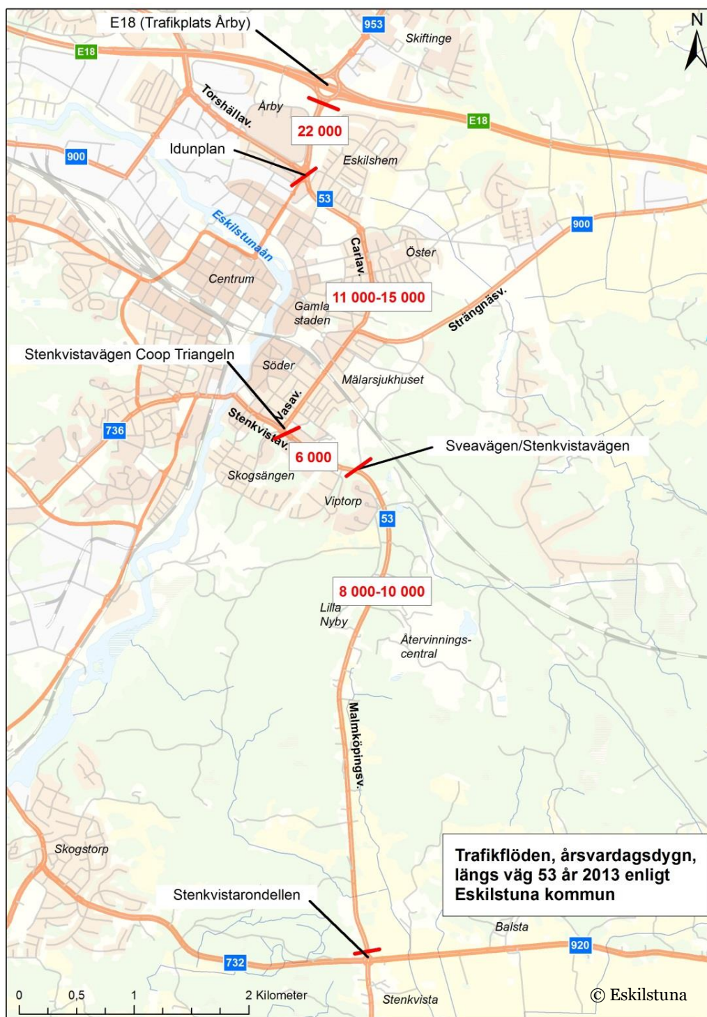
Figur 5 Trafikflöden inom Eskilstuna tätort, fordon per årsvardagsdygn, 2013. Källa: Stadsbyggnadsförvaltningen, Eskilstuna kommun.
