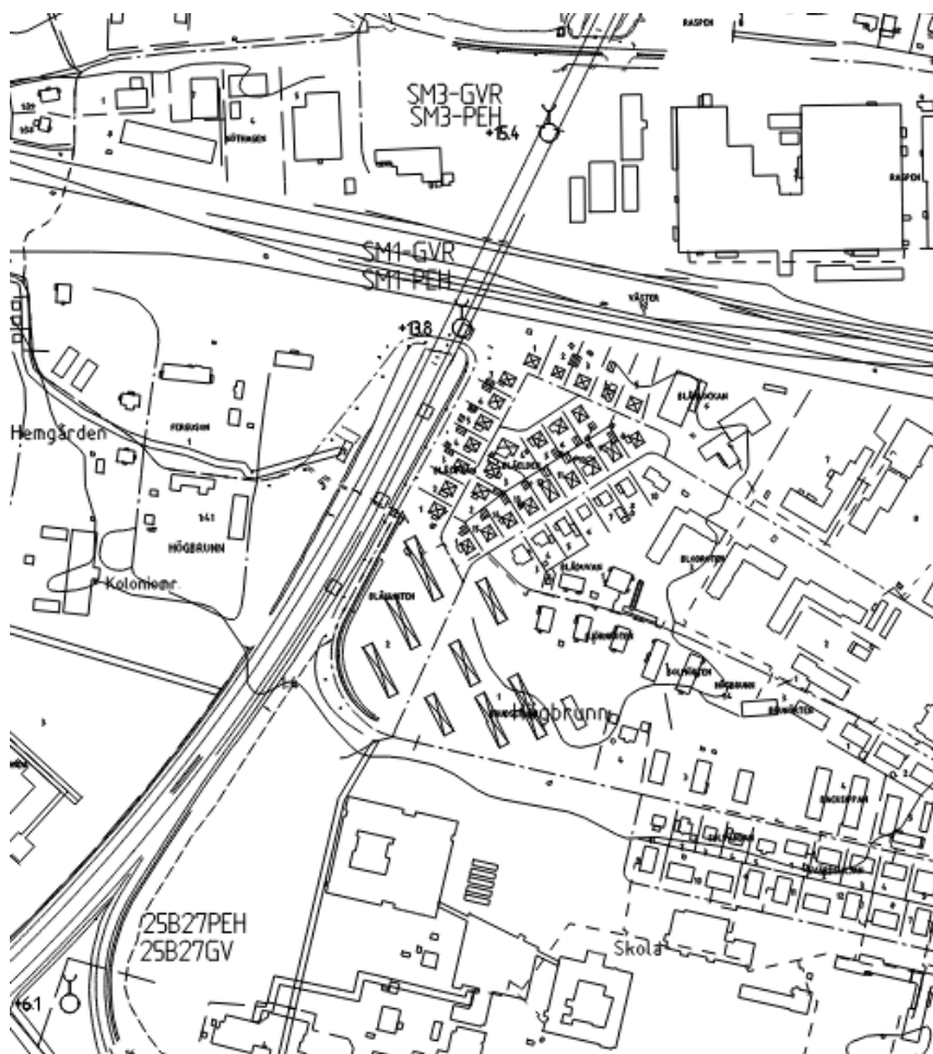
Figur 7: Installerade grundvattenrör benämnda SM3GVR, SM3PEH, SM1GVR, SM1PEH, 25B27GV och 25B07PEH.
