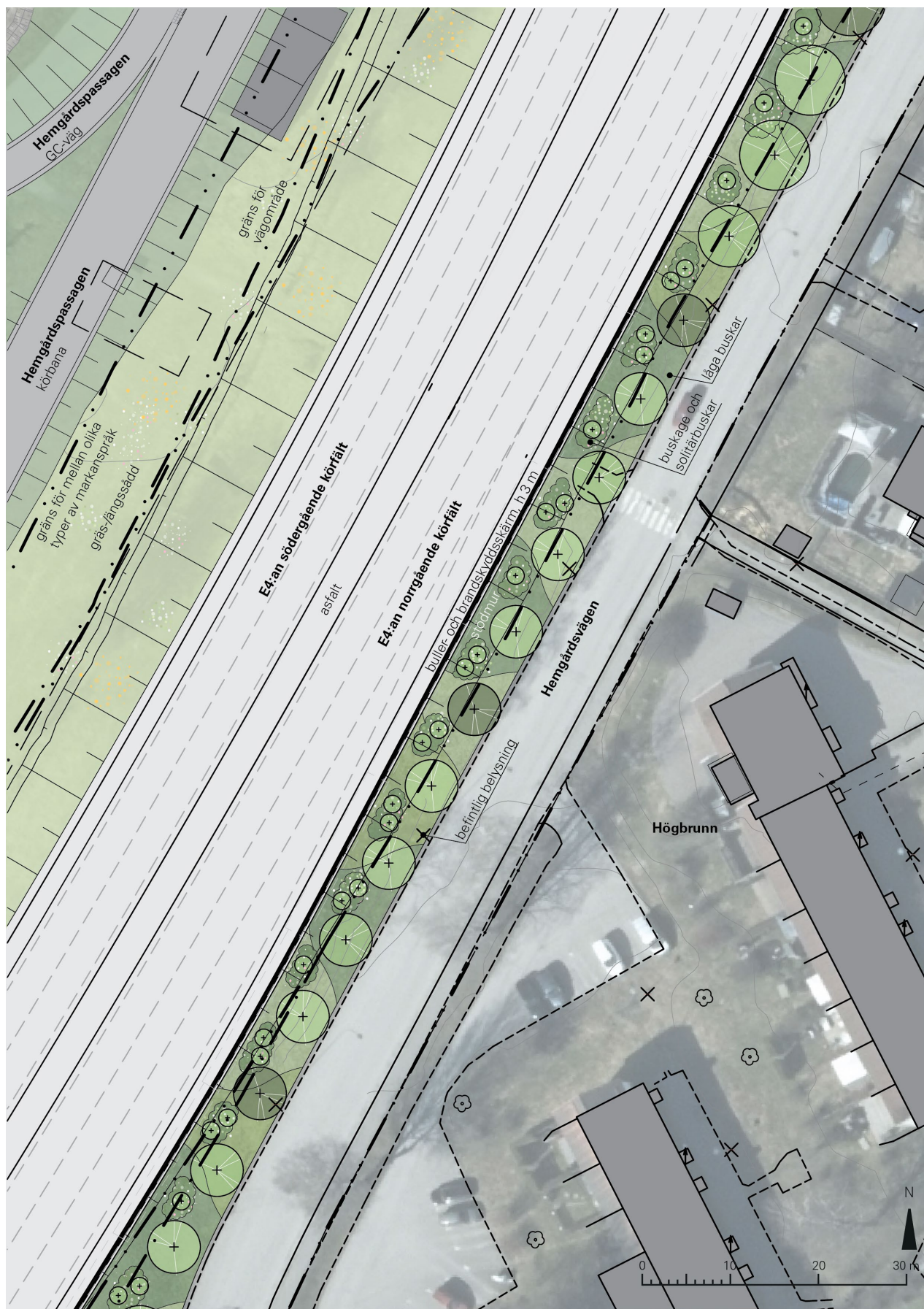
Figur 21. Illustrationsplan, planutsnitt 4. Stödmur och princip för vegetation i slänt mot Högbrunn. Flygbild ©Lantmäteriet.
