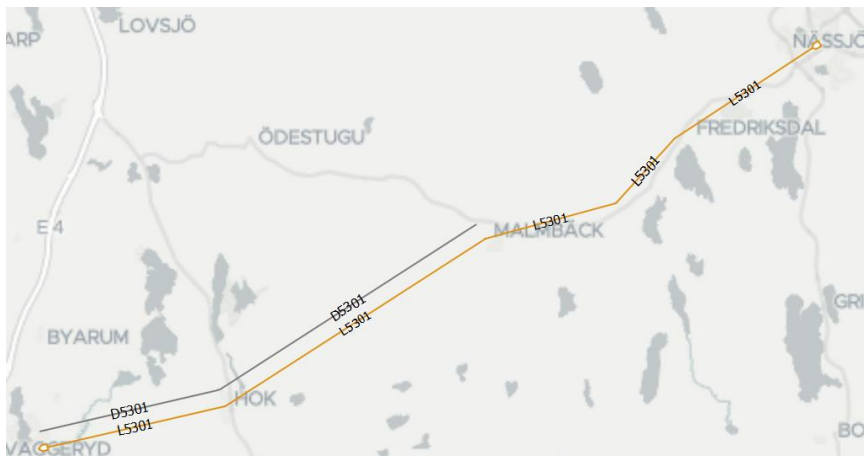
Figur 2. Exempel på linjedel. Bilden visar linjedel L5301 (Nässjö Central-Vaggeryd) med tillhörande dimensionerande sträcka D5301 (Malmbäck-Vaggeryd).
