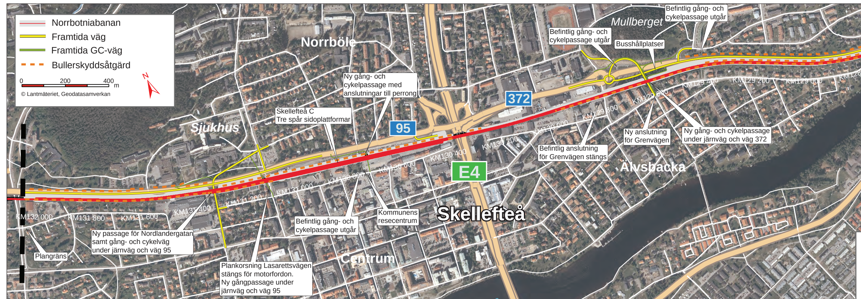
Figur 5.2:1 Den planerade järnvägens utformning, västra delen.
