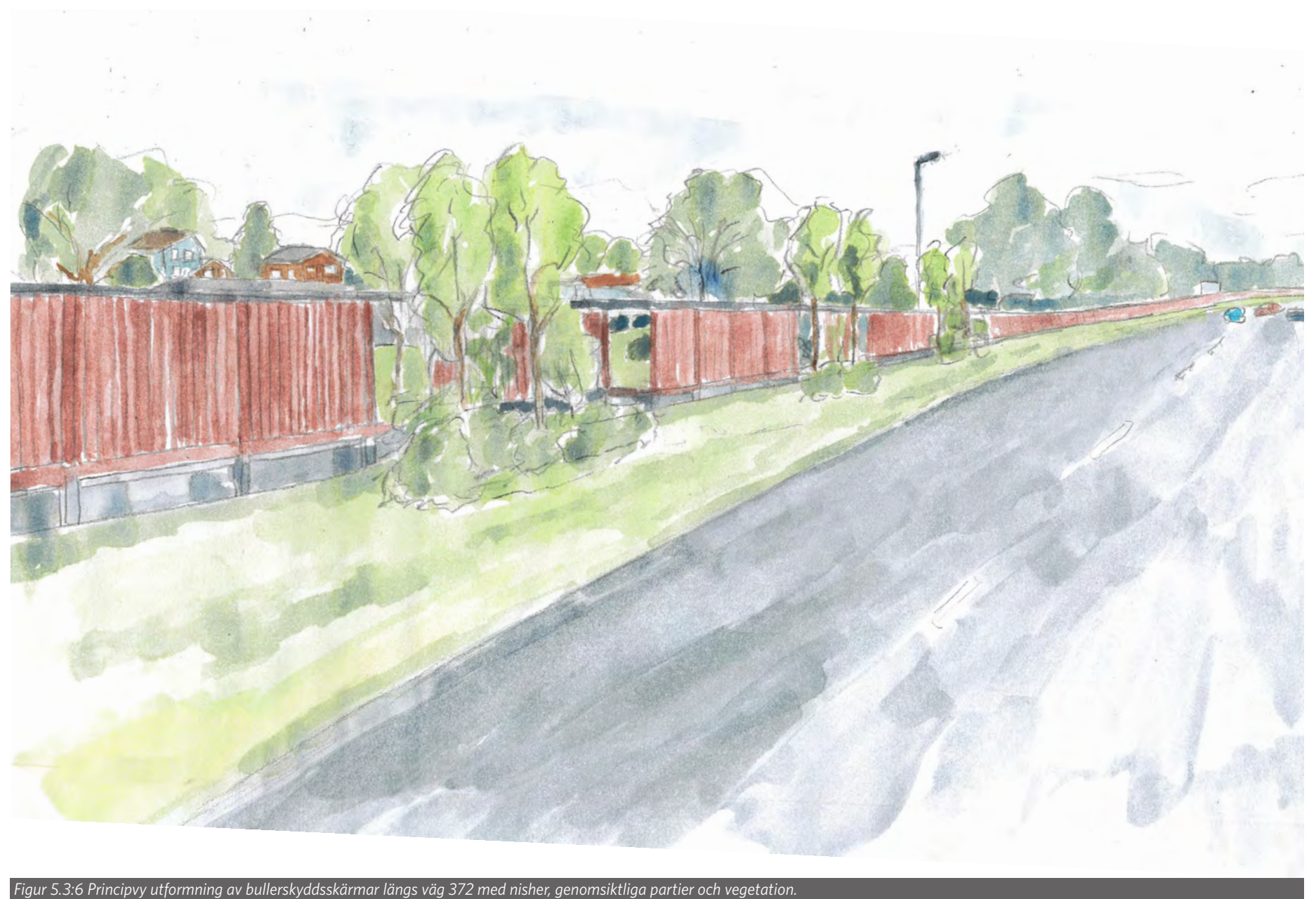
Figur 5.3:4 Bullerskärm med inschack, glasade partier och vegetation.
