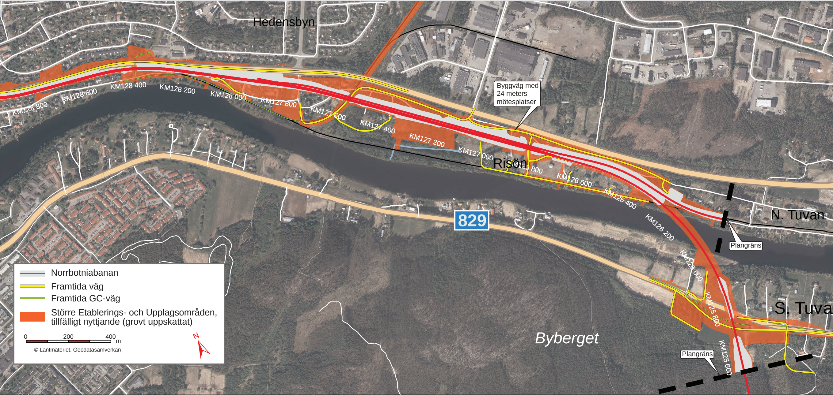
Figur 4.2:14 Den planerade järnvägens utformning samt större arbets- och upplagsområden under byggtiden.
