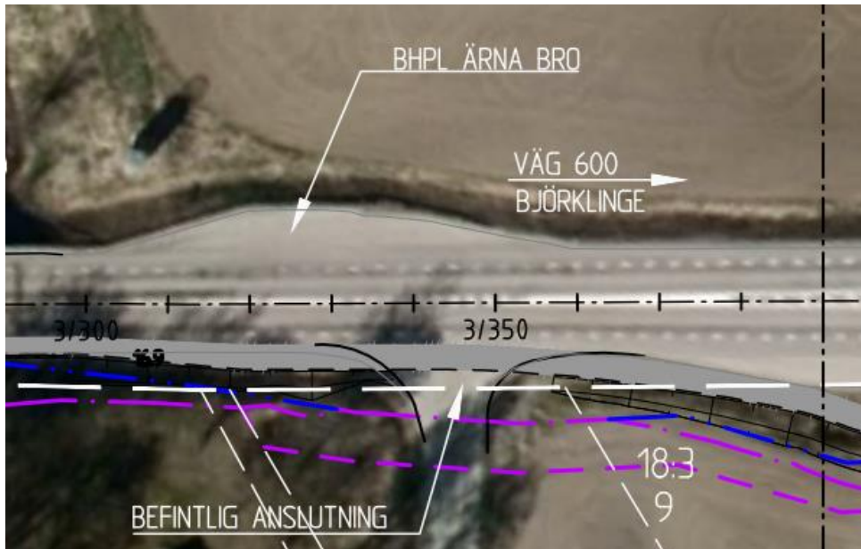
Figur 7. Redovisning av busshållplats i tidigare fastställd vägplan. Ingen förändring av hållplats ingick. Mörkblå linje visar gräns för befintligt vägområde, lila streck-prickad linje visar gräns för nytt vägområde och lila streckad linje visar gräns för tillfällig nyttjanderätt.
