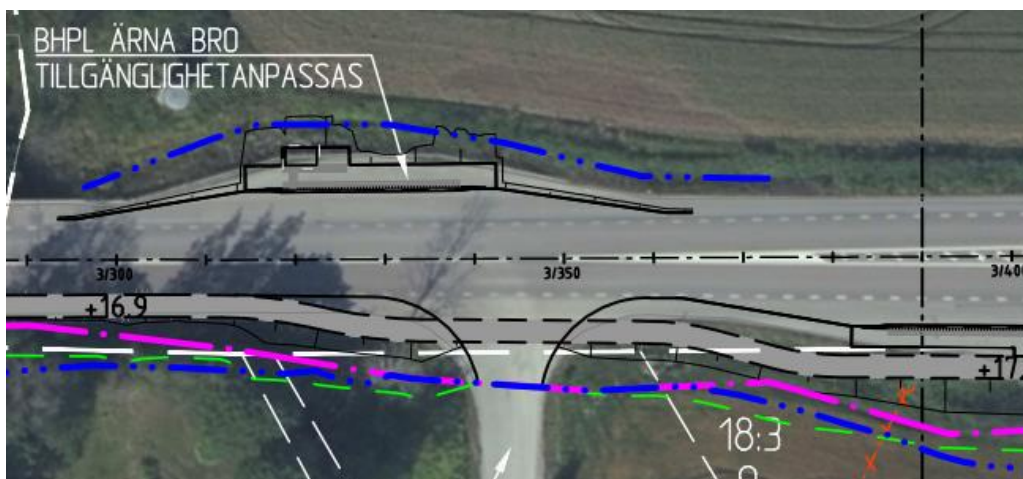
Figur 8. Redovisning av busshållplats i ändring av vägplan där hållplatser rustas upp och tillgänglighetsanpassas. Mörkblå linje visar gräns för befintligt vägområde, lila linje visar gräns för nytt vägområde och grön linje visar gräns för tillfällig nyttjanderätt.
