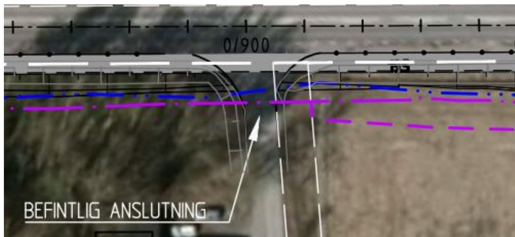
Figur 5. Gång- och cykelvägens passage över anslutande vägar till väg 600 enligt tidigare vägplan. Mörkblå linje visar gräns för befintligt vägområde, lila streck-prickad linje visar gräns för nytt vägområde och lila streckad linje visar gräns för tillfällig nyttjanderätt.
