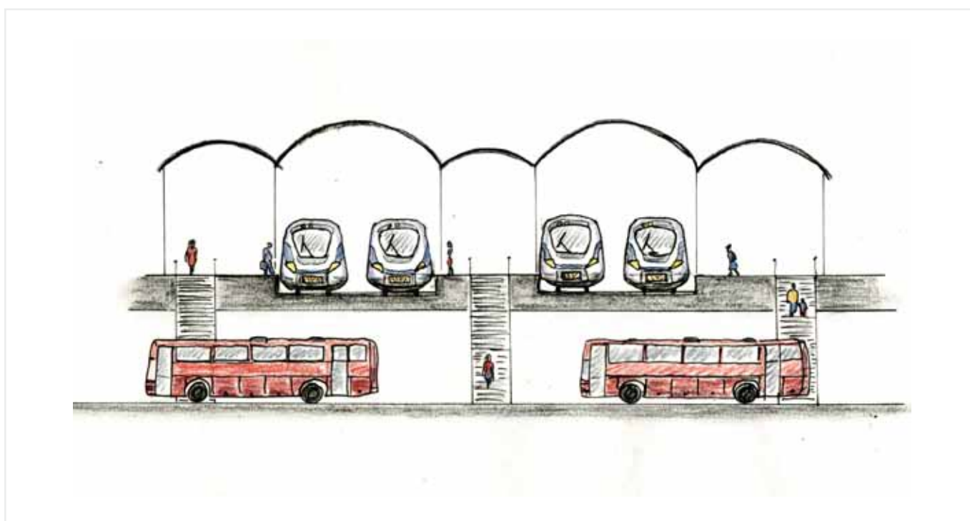
Figur 5.2.2 Skiss över systemlösning för bytestpunkt i två plan som medger korta bytestider. Från förstudien för Linköping C – Mantorp.
