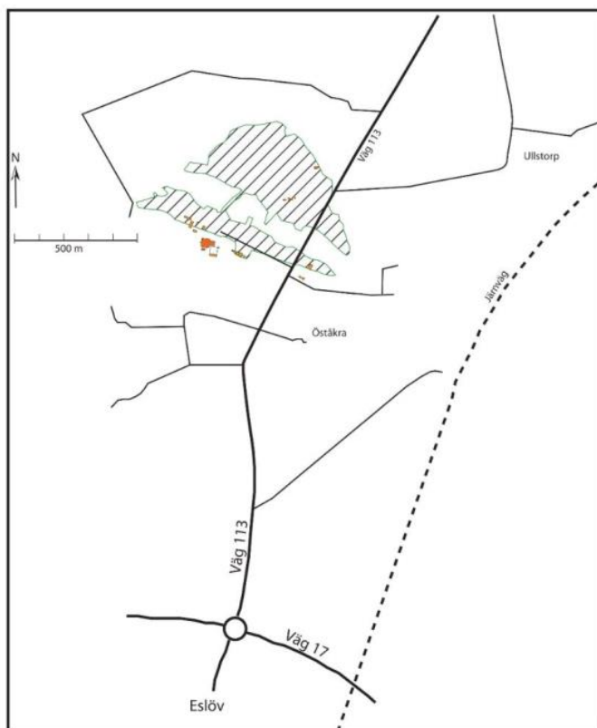
Skiss visande de utbrutna delarna av kolfliötsen. Skissen omfattar både övre- och undre flöts
