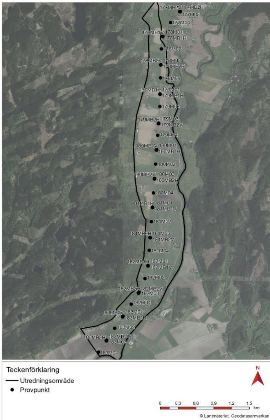
Figur 43. Prover tagna under 2019 inom Trafikverkets projekt, Spår- och kontaktledningsbyte Borås-Varberg.
