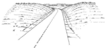
Propellerslänt har en varierande lutning och förenar släntrön och släntfot i en mjuk linje (Hermansson 1999).
