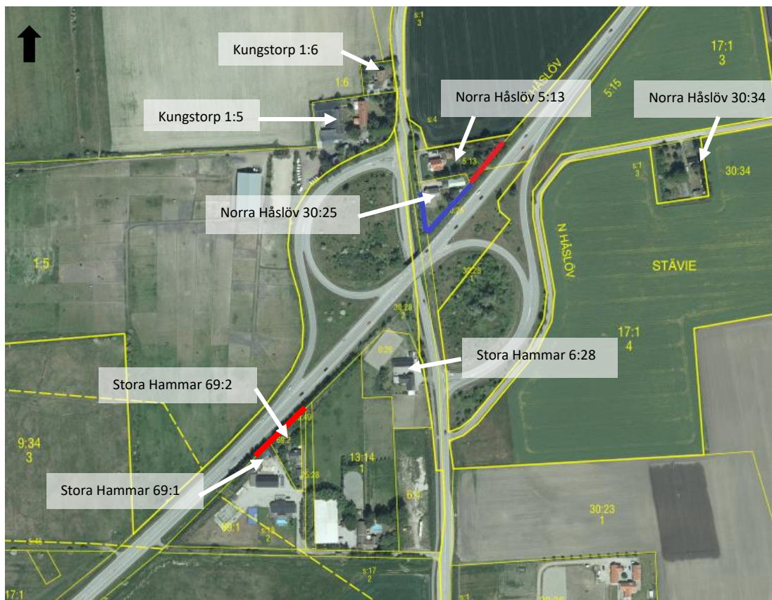
Figur 25. Planerade vägnära bullerskyddsåtgärder vid trafikplats Kungstorp. Befintligt bullerskydd markeras med blå linje och planerat nytt bullerskydd markeras med röd linje. Källa: Lantmäteriet.
