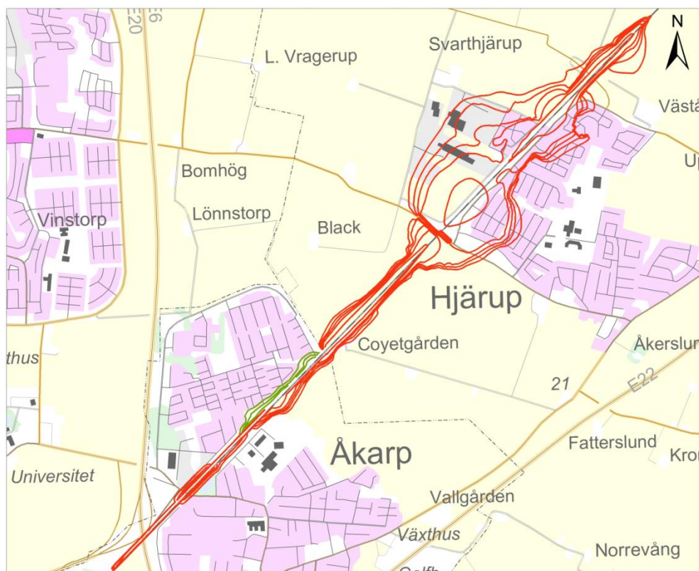
Figur 12.1 Grundvattenpåverkan i Åkarp och Hjärup under byggtiden. Gröna linjer visar höjning av grundvattenytan, röda visar sänkning.
