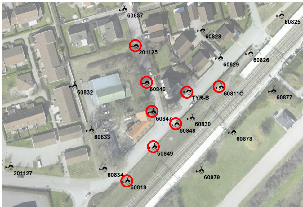
Figur 9.6 Grundvattenrör för provtagning av CAH. Röda cirklar visar de grundvattenrör där analysresultat presenteras nedan.
