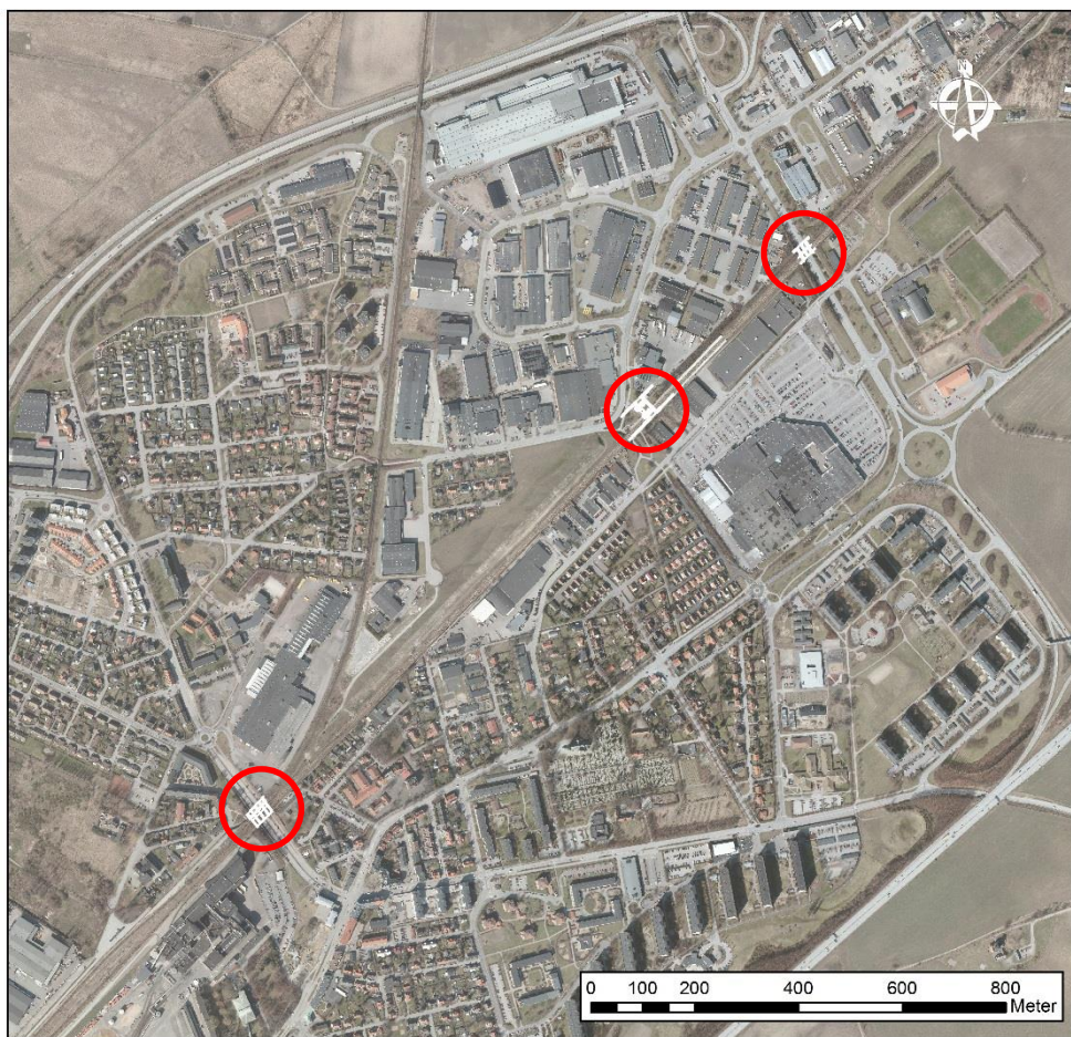
Figur 12.4 Punkter i Arlöv där grundvattenytan lokalt kommer att sänkas i samband med anläggande av brostöd. Sänkningen sker i områden som redan är störda av befintliga underfarter och där markanvändningen domineras av vägar, parkering och industrier.
