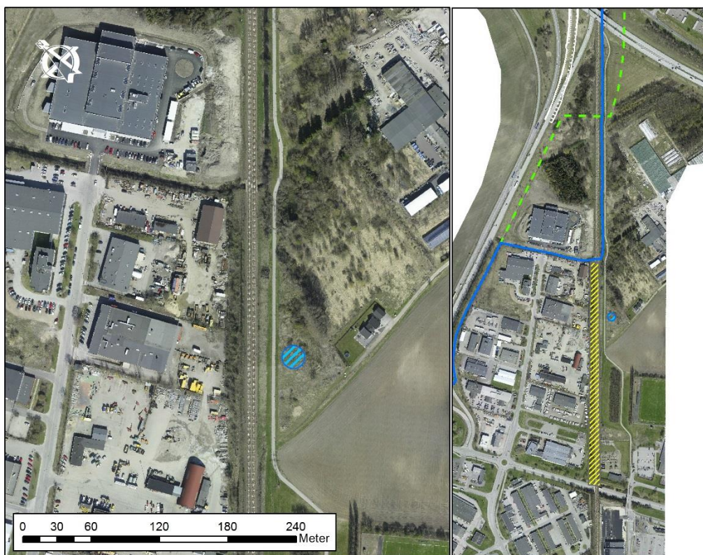
Figur 7.21 Till vänster, utjämningsmagasin tillhörande dräneringspump 5 (DPU5). Vattnet kommer att ledas till Alnarpsån, söder om magasinet. Till höger, det spårrområde som avvattnas till magasinet markerat med gul skraffering. Grönstreckad linje visar Alnarpsåns nya draging.
