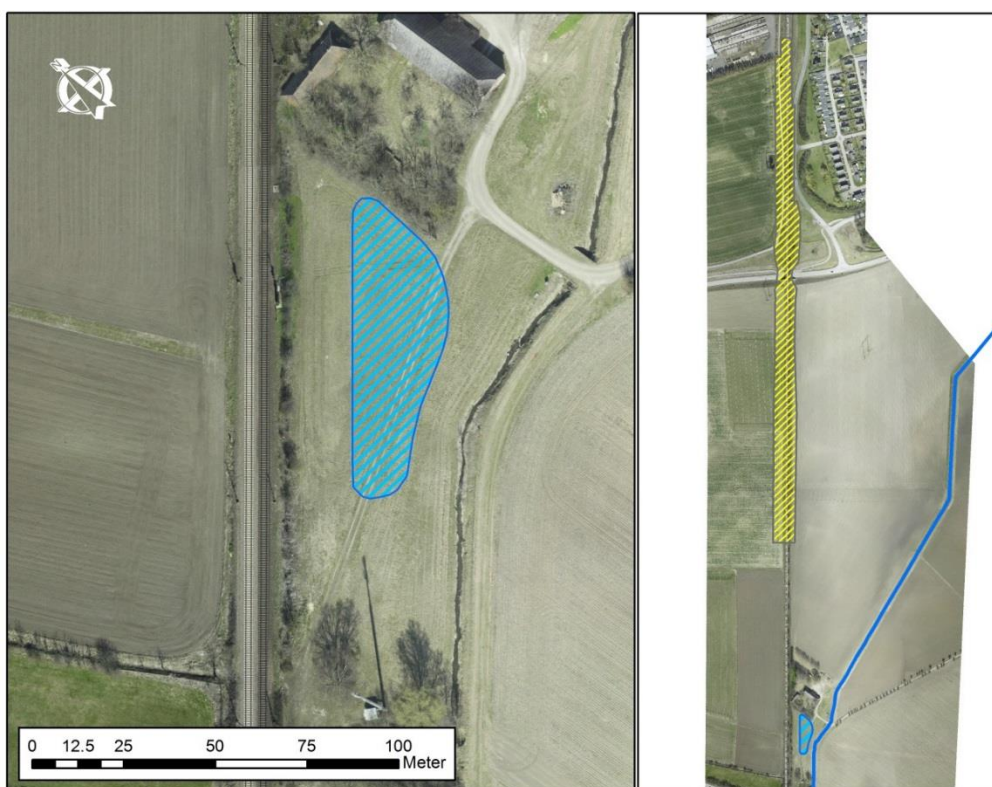
Figur 7.17 Till vänster, utjämningsmagasin tillhörande dräneringspump 2 (DPU2). Vattnet kommer att ledas till Alnarpsån, öster om magasinet. Till höger, det spårområde som avvattnas till magasinet markerat med gul skraffering.
