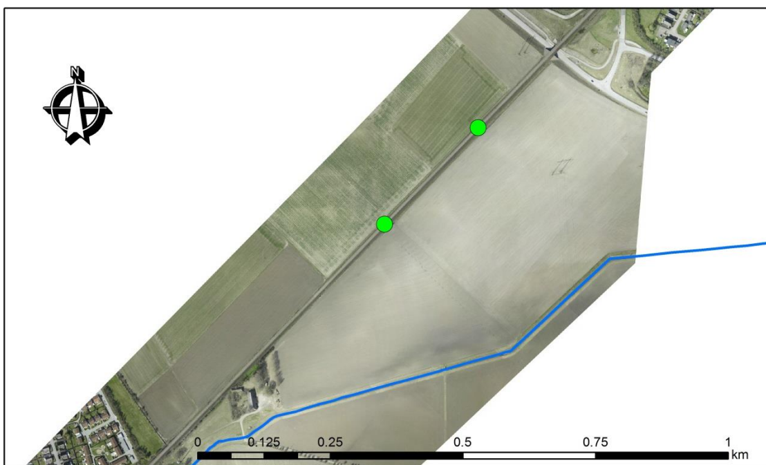
Figur 7.2 Gröna punkter visar var täckdiken korsar spåren i dagsläget. Markavvattningen från åkern kommer i permanentsskedet att ledas mot sydväst istället för mot sydost. Det förutsätts att avvattningen från åkermark har ett trögare flödesförlopp än avvattning från urbana ytor, och att de två därför inte tidsmässigt sammanfaller.
