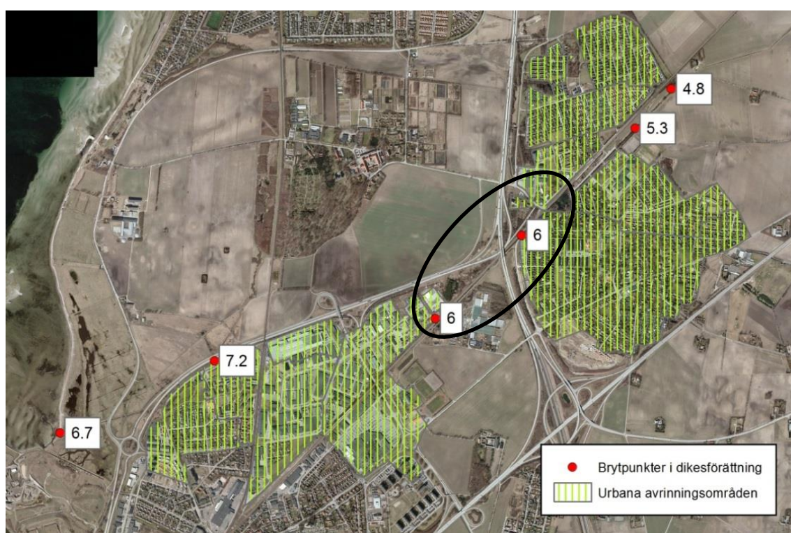
Figur 3.9 Dimensionerande vattenföring enligt dikesförrättning från 1983. Siffrorna anger tillåtet flöde i varje punkt. Skillnaden mellan två på varandra följande siffror blir således det tillåtna tillskottet längs sträckan. Svart markering anger sträcka där diket kommer att påverkas av järnvägens utbyggnad.
