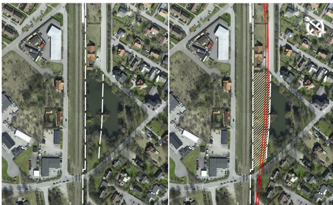
Figur 7.5 Till vänster, första etappen av dammutfyllnaden. Spont slås/vibreras över dammen för att skärma av område där banvallen kommer att gå. Spont slås/vibreras även mot det sänkta spårområdet för Södra stambanan. Till höger, andra etappen då banvall anläggs och spår dras över dammen
