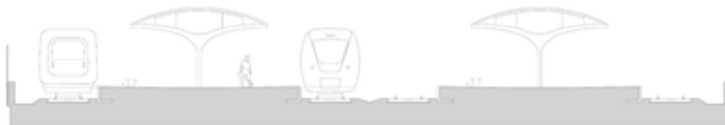
Perrongerna förses med väderskydd, sektionen visar ett exempel på bågformade.
