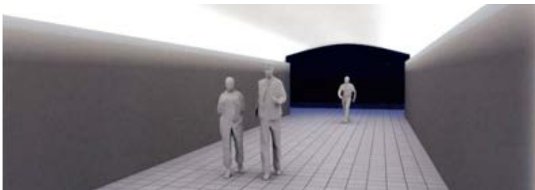
Nedan. Uppljus i taket med långsgående armatur.
