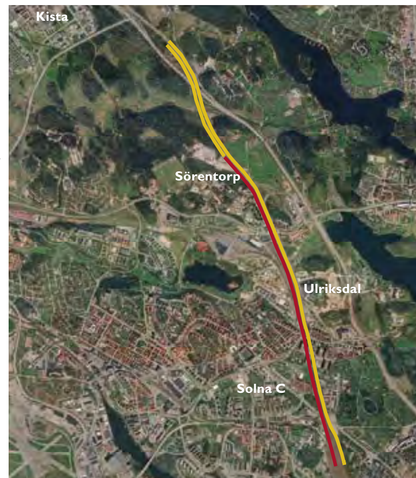
Flygbild. Sträckor där spår anläggs intill de befintliga är markerade med gul färg, där befintligt driftspår föreslås nyttjas för Mälardalens är markerade med röd färg.
