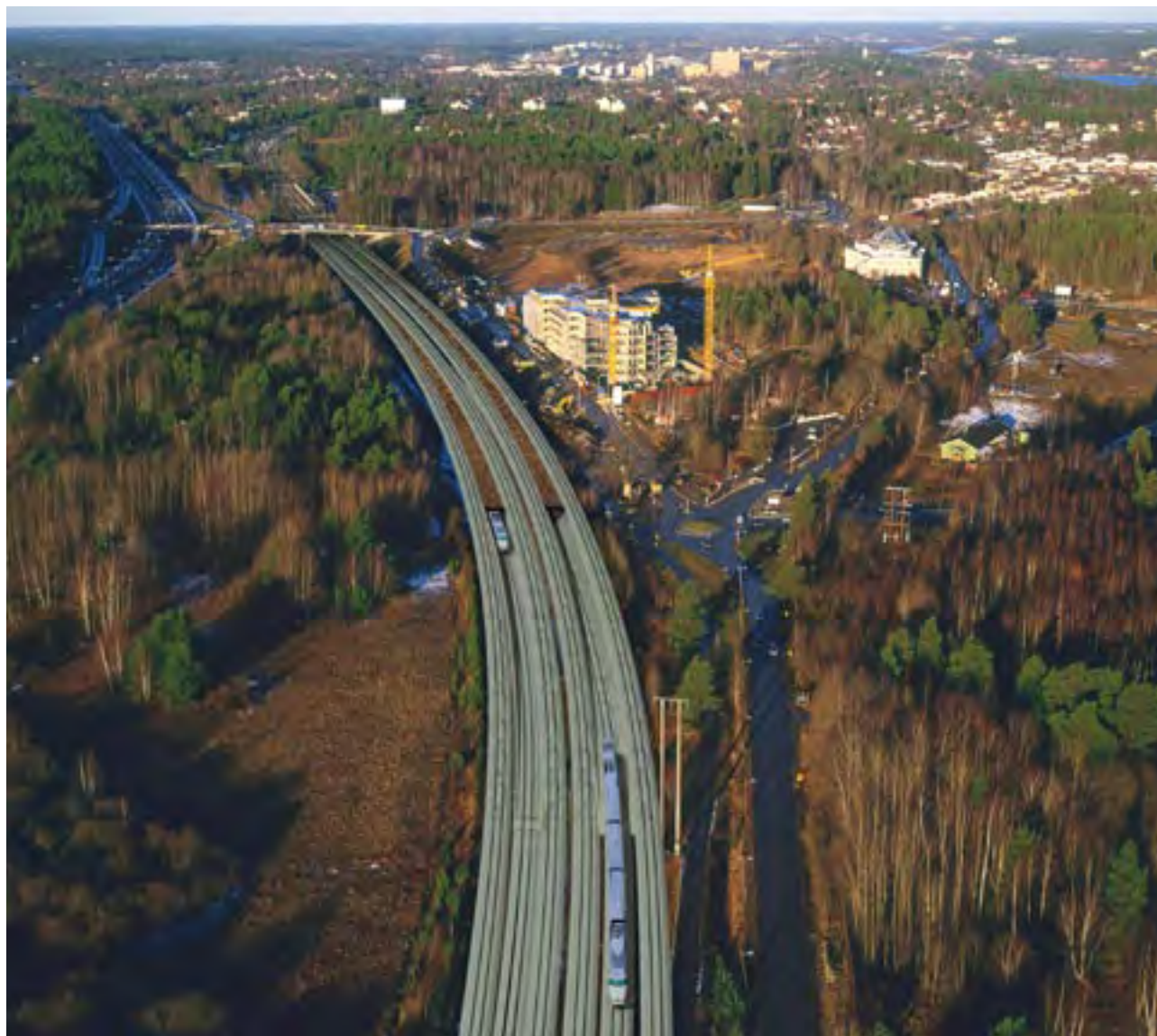
Fotomontage, tunnelmykning Ostkustbanan vid Silverdal. Denna typ av lösning är möjlig för både Kista korridor – Kista centralt och Kista korridor – Kista Helenelund. Eventuellt skulle anslutningen kunna byggas i nytt läge mellan befintlig anläggning och motorvägen. Befintliga spår skulle rivas när de nya är klara.
