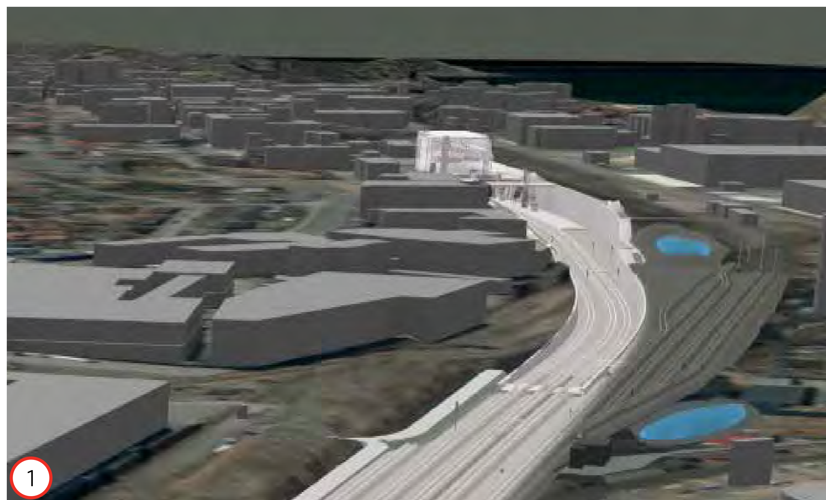
Järnvägen går nedsänkt i tråg genom centrala Varberg. Bilden redovisar inte kontaktledningsstolpar eller plattformstak.
