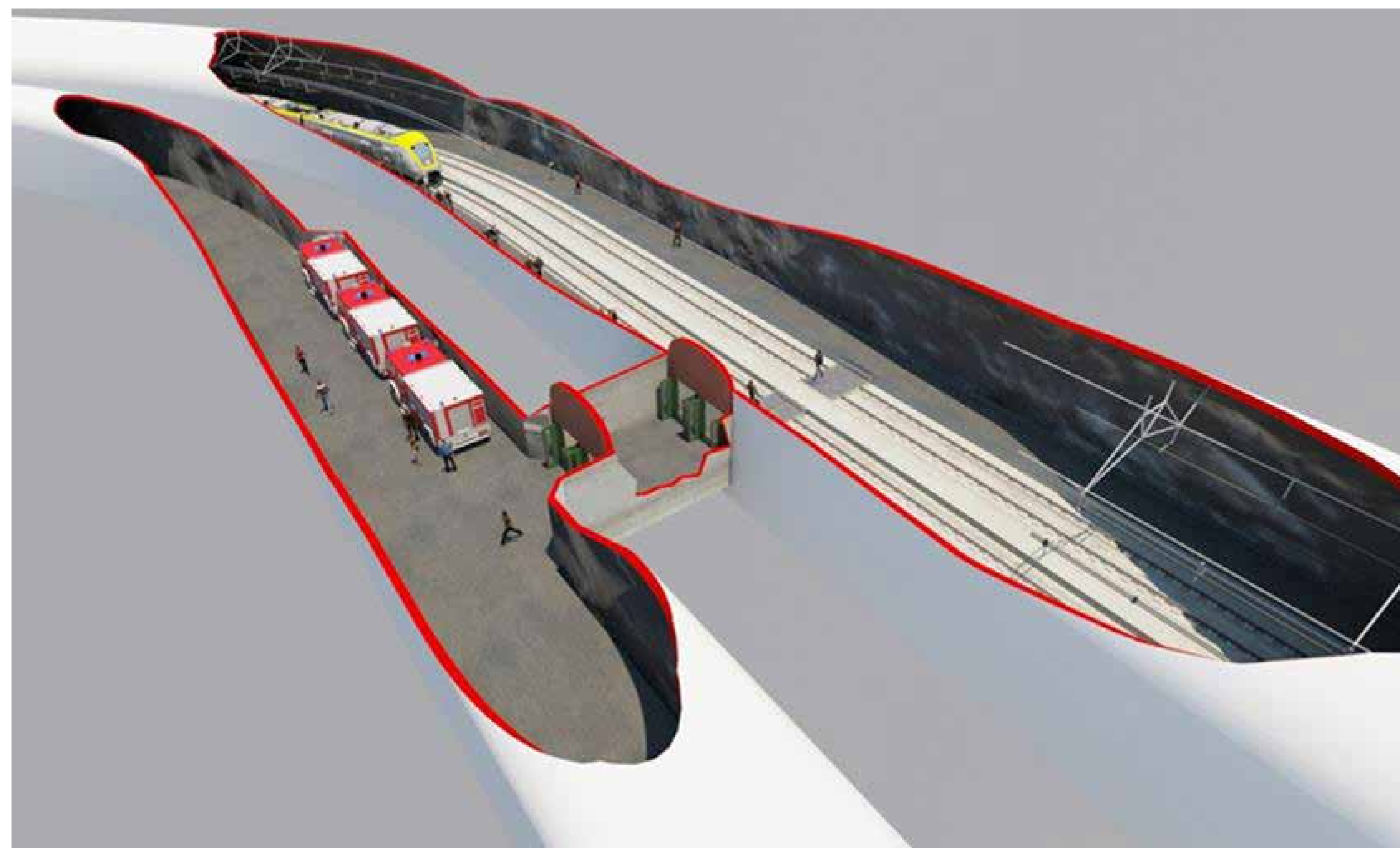
Illustration av service- och räddningstunnel och järnvägstunnel. Exempelbild från Västlänken i Göteborg.
