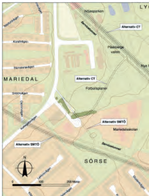
6.2:10 Illustrationen visar mellanpåslaget vid Kattegattvägen för de båda alternativen SMTÖ och CT.
