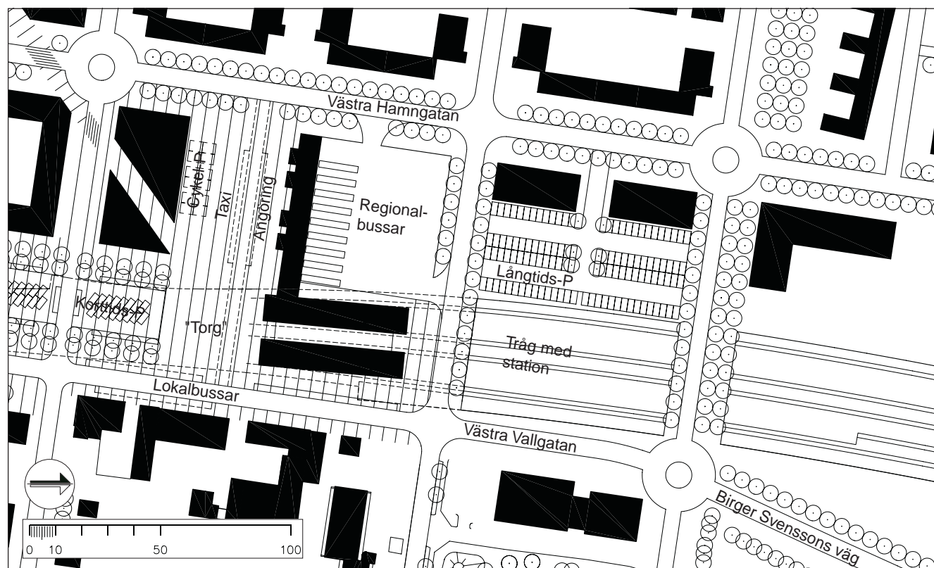
43:5 Plan över studerad utformning av sambanden mellan olika trafikslag vid alternativ SMTÖ. (Obs! Norr är åt höger på planen.)
