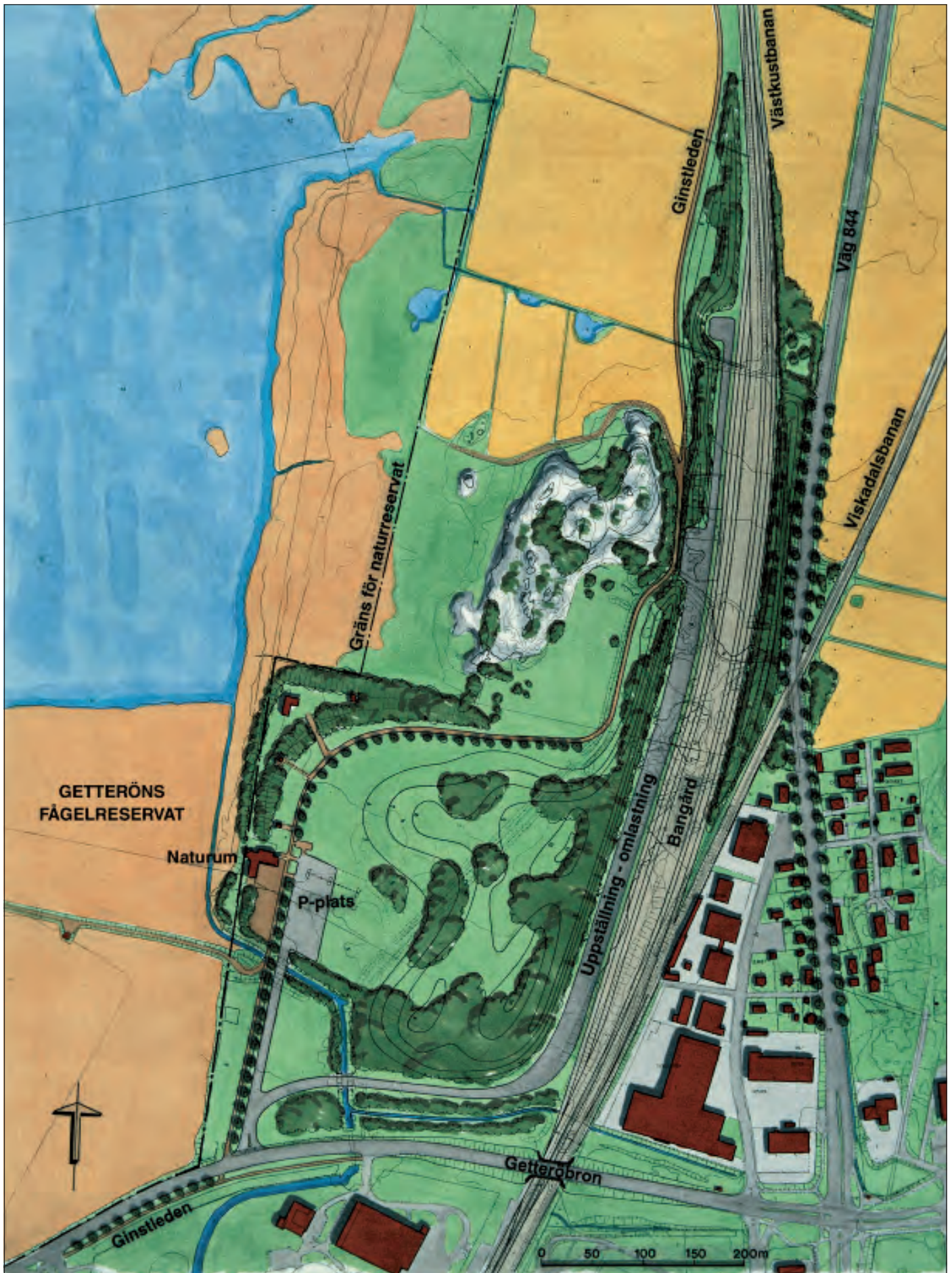
4.3:14 Illustrationsplan med bangård nord och föreslagen deponi för schaktmassor.
