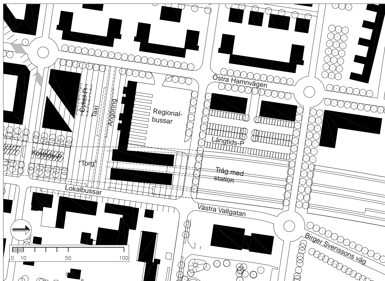
4:10 Plan över studerad utformning av sambanden mellan olika trafikslag vid alternativ SMTÖ. (Obs! Norr är åt höger på planen.)
