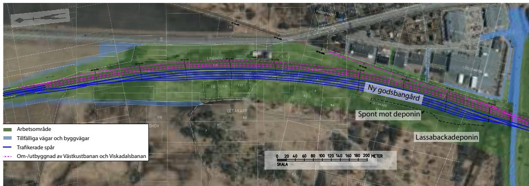
Figur 4.5 Byggskede när ny godsbangård i norr är klar, befintliga spår byggs om och nya förbigångsspår byggs.
