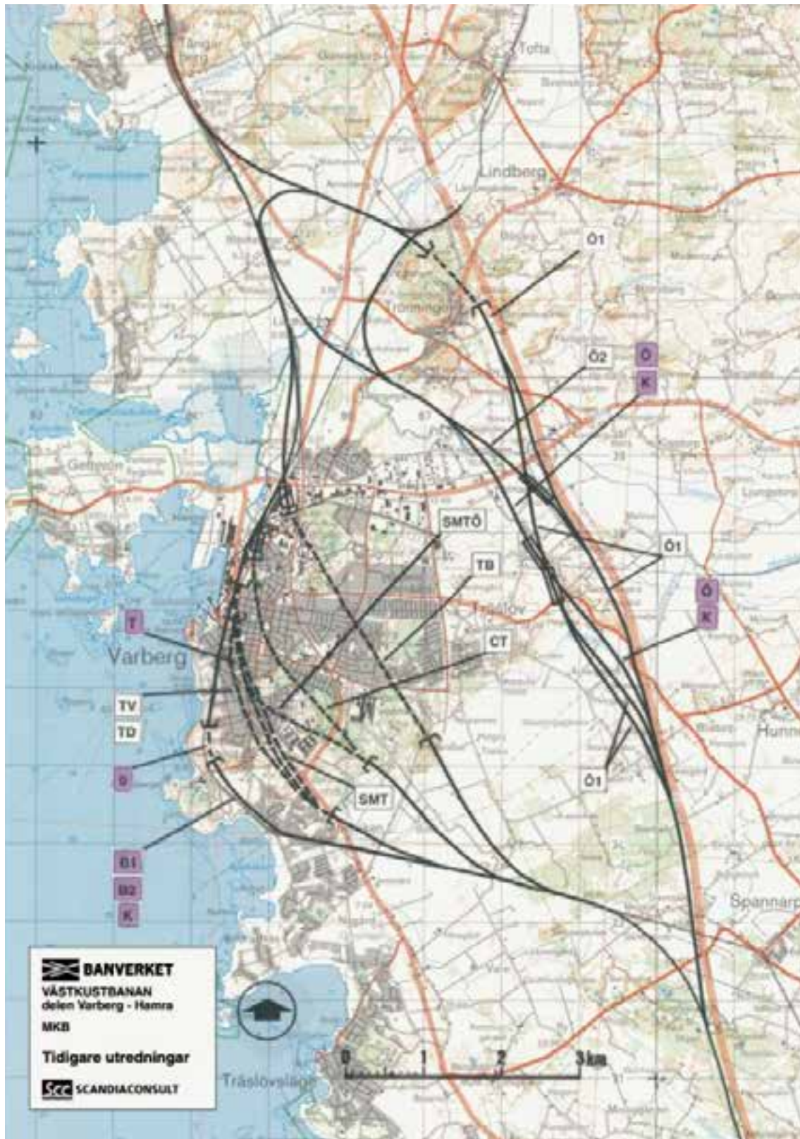
Figur 1.2 Studerade sträckningar i Banutredningen. Bokstäverna står för de olika alternativa sträckningar som studerades: Tunnel under Vallgatan (TV), Tunnel under Domus (TD), Stadsmiljö tunnel (SMT, SMTÖ), Centrumtunnel (CT), Tunnel under Brunnsberg (TB) och en östlig sträckning (Ö1, Ö2). Bild från järnvägsutredningen.
