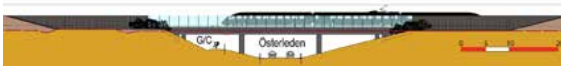
Figur 3.23 Vy mot öster. Längdsektion på trefacksbro där Österleden går under järnvägen. Gång- och cykelvägen förläggs norr om Österleden.
