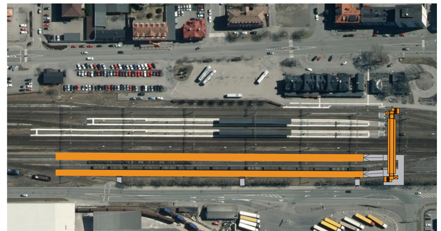
Figur 5.5. Tillfallig bangard och tillfallig bro. I forsta skedet kommer befintliga plattformar som ocks ses pa bilden nyttjas medan tillfalliga spar byggs.
